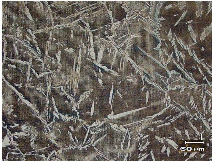
**Figura 27. Micrografía por M.O. del cordón (ZF) de la muestra enfriada con aire forzado, donde se aprecia una reaparición de la austenita con una morfología tipo placa en los límites de grano, y tipo placa y listón en el interior de los granos de la fase ferrítica. 200X.**
