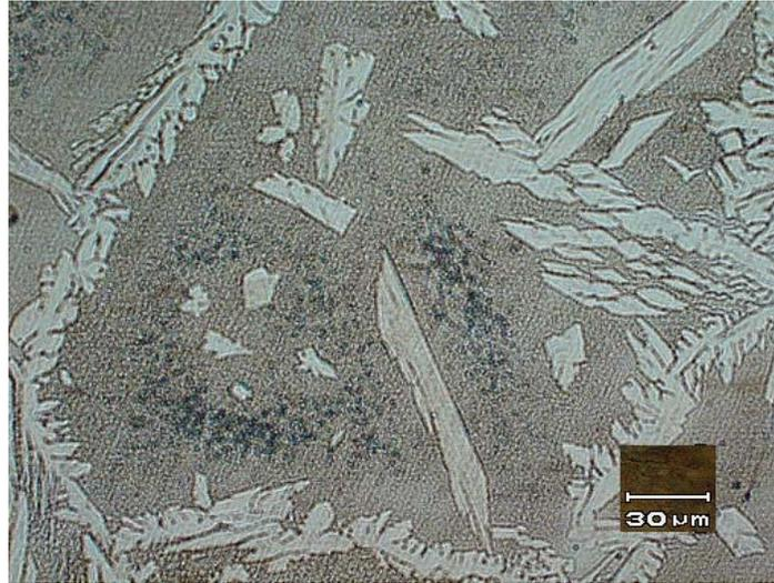
**Figura 25. Micrografía por M.O. de la ZAC donde se observan posibles precipitados de fases minoritarias localizados entre las placas de austenita (fase clara). 500X.**
