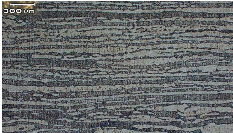
**Figura 1. Micrografía por M.O. de un acero inoxidable dúplex, con una microestructura bifásica de ferrita (oscura) y austenita (clara). 50X.**
