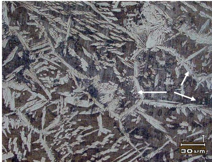
**Figura 26. Micrografía por M.O. del cordón (ZF) de la muestra enfriada en agua, donde se aprecia una reaparición de la austenita con una morfología tipo placa en los límites de grano, y tipo placa y listón en el interior de los granos de la fase ferrítica. Nótese la formación de placas secundarias de austenita en las placas primarias (flechas). 200X.**
