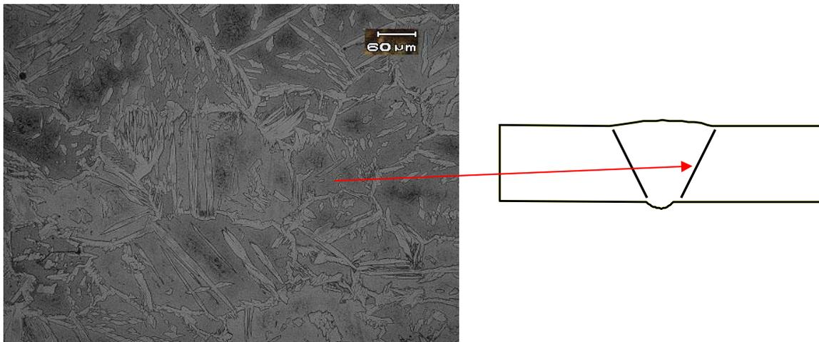
**Figura 30. Micrografía por M.O. de una región de la ZAC de una muestra enfriada con aire forzado.**
