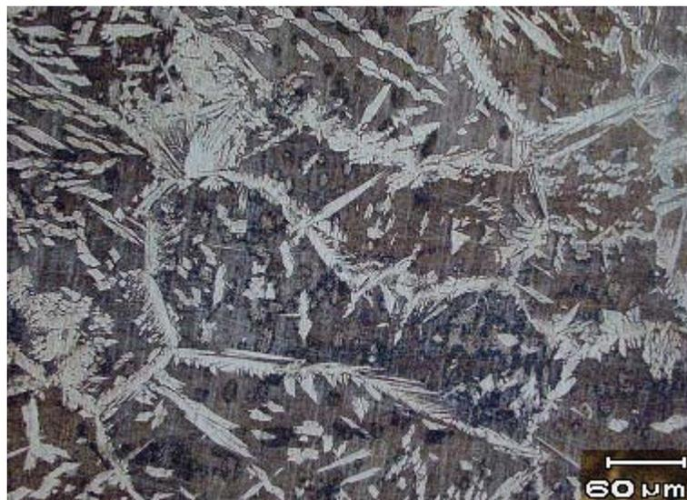
**Figura 22. Micrografía por M.O. de la ZAC de una muestra enfriada en agua, donde se observa una austenita (fase clara) con morfología de placa o acicular tipo Widmanstätten, localizada en los bordes de grano de la ferrita y en el interior de los granos de la matriz ferrítica. 200X.**
