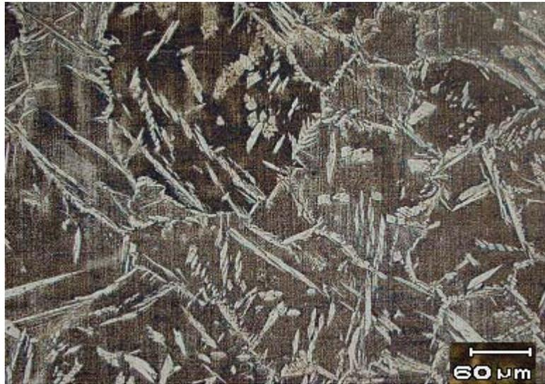
**Figura 23. Micrografía por M.O. de la ZAC de una muestra enfriada con aire forzado, donde se observa la austenita (fase clara) con una morfología de placas (tipo Widmanstätten), localizada en los bordes de grano de la ferrita y en el interior de los granos. En el interior de éstos, su morfología se presenta también como de tipo listón. 200X.**
