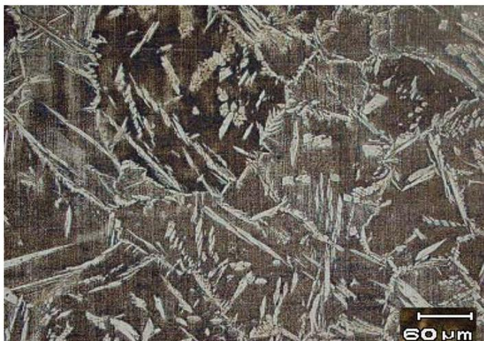
Fig. 9. Micrografía por M.O. donde se observa la austenita con una morfología acicular, o de placas, tipo Widmanstätten (fase clara). 200X.
