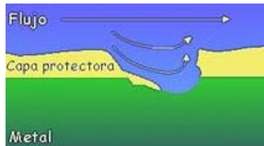
Fig. 10. Corrosión Erosión: corrosión inducida por el flujo del medio electrolítico.
