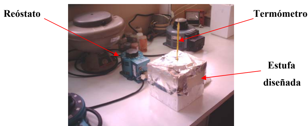
Fig. 13. Sistema diseñado para alcanzar y mantener la temperatura a 37 °C.
