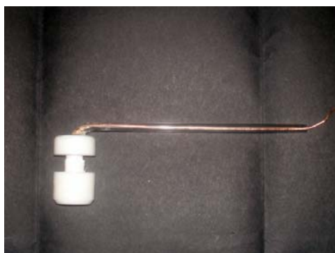
Fig. 14. Porta-muestra diseñado para la realización de las curvas de polarización potenciodinámicas.
