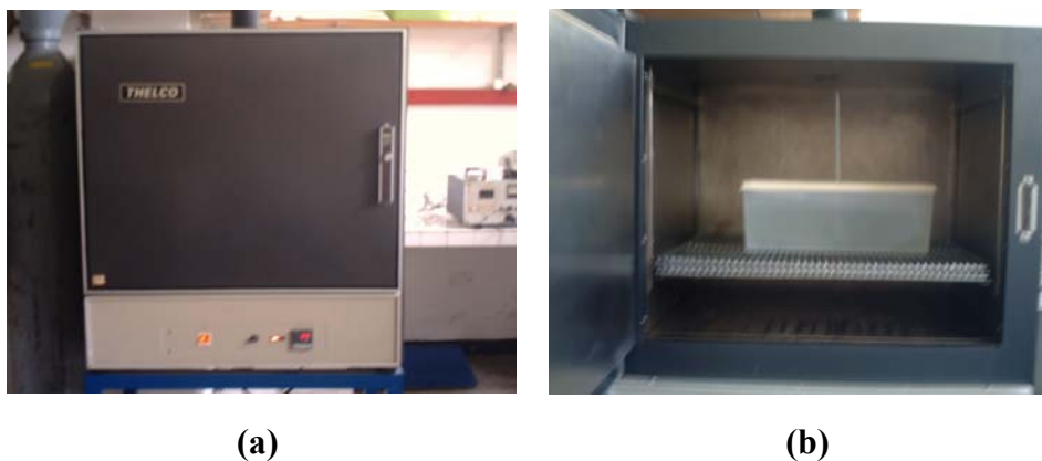
Fig. 15. Sistema utilizado para los ensayos de corrosión. a) vista frontal de la estufa, b) recipiente de plástico donde se colocan las muestras para el ensayo de corrosión.
