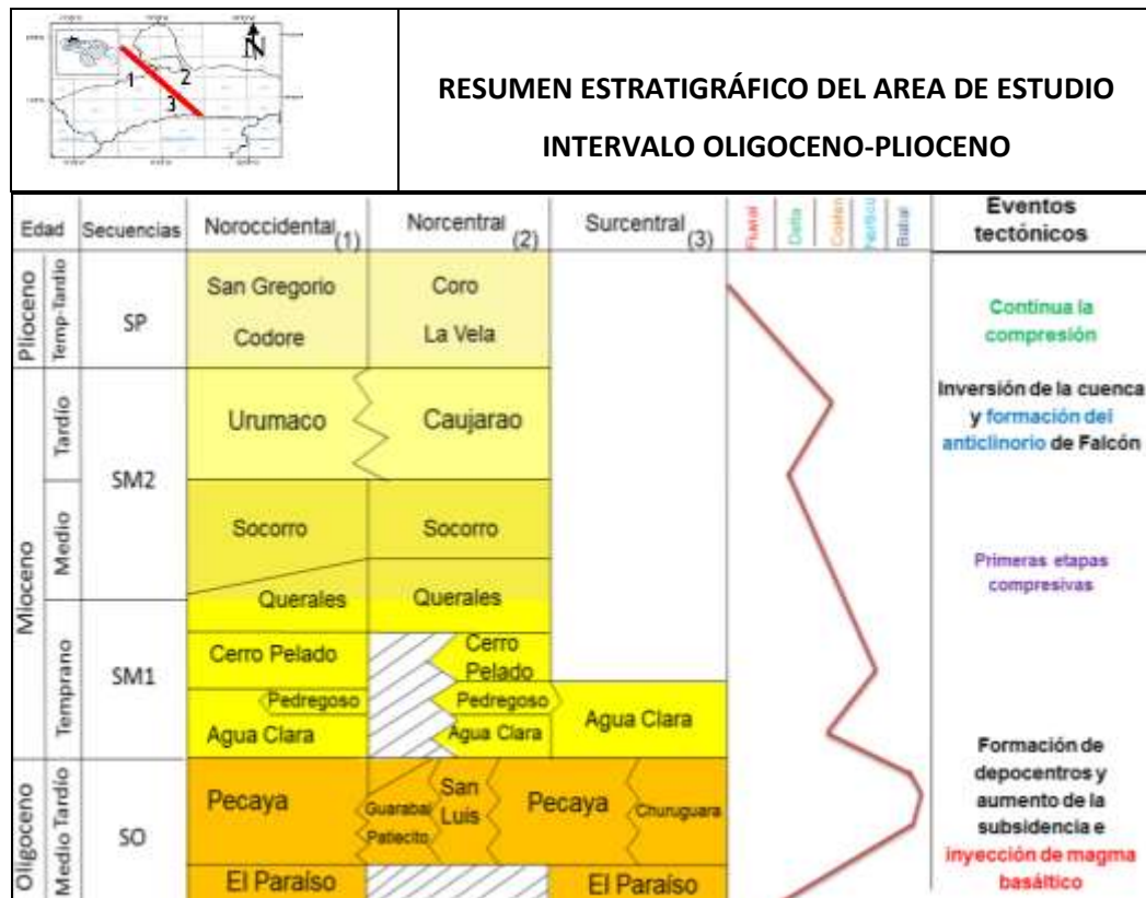
Figura 10. Cuadro resumen de la correlación estratigráfica de la Cuenca de Falcón, representando sus correspondientes paleoambientes y eventos tectónicos (tomado y modificado de Camposano et al., 2009).
