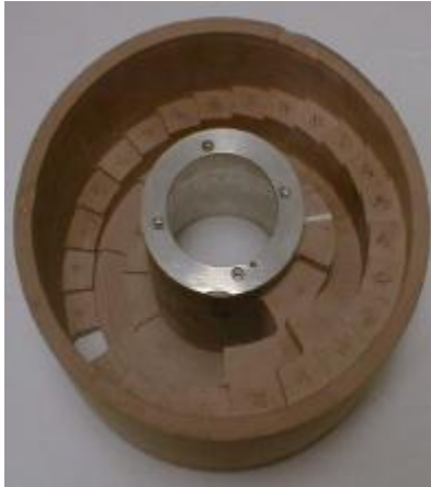
Fig.V.6. Modulador de alcance tipo ‘rueda’ con 3 pistas que se usan para diferentes anchos de modulación. Tomado de [Pa05].
