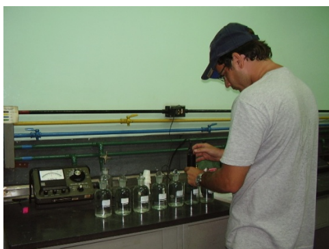
Medición de Oxígeno disuelto
