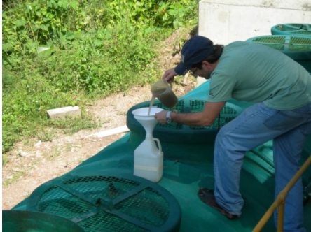
Captación de muestra del reactor
