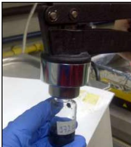
Figura 34. Sellado del vial con fracción del pirolizado
