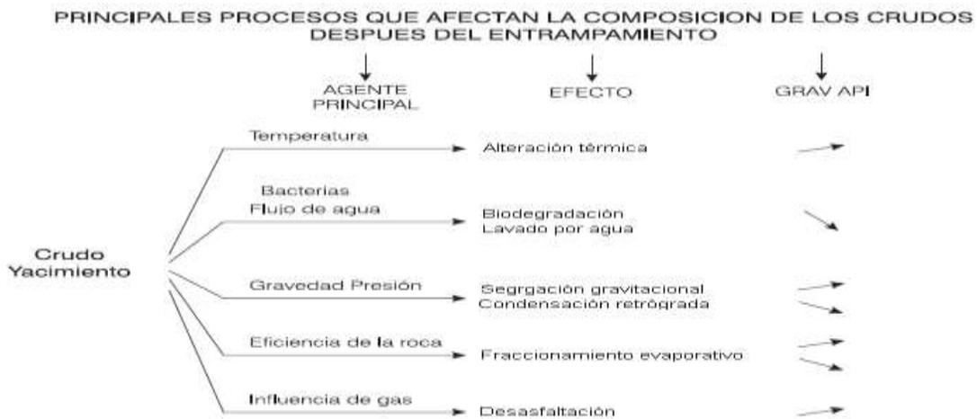
Figura 3. Procesos que afectan la composición del crudo después del entrapamiento
