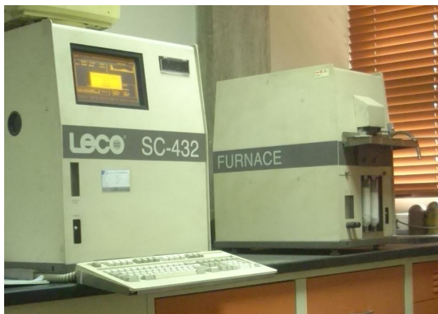
Figura 21. Equipo analizador marca LECO, modelo CS-432 utilizado en el presente estudio.
