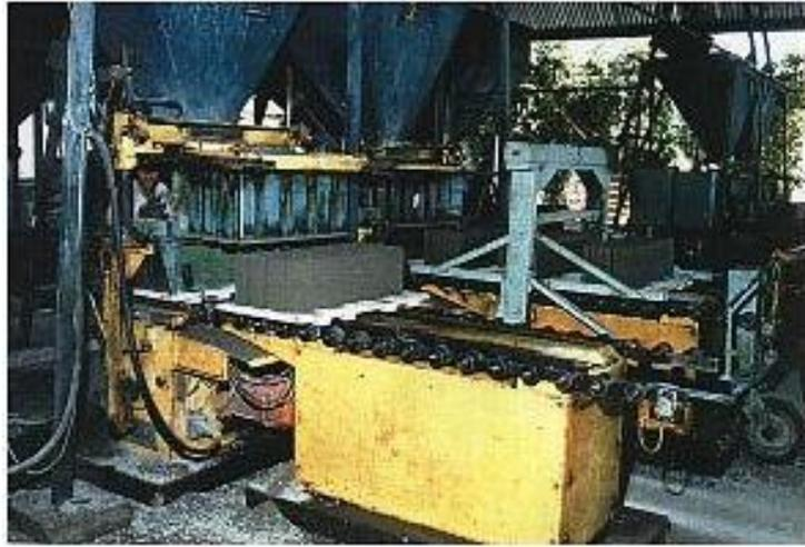
**Figura 40.** Equipo utilizado para la fabricación de cerramientos y bovedillas. Fuente: Ing. Luis M. Sanz (2015)
