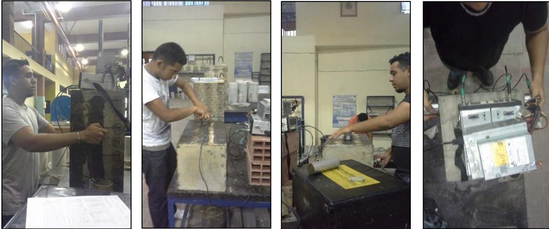
Figura 3.32 Ensayo de Velocidad de Pulso Ultrasónico
