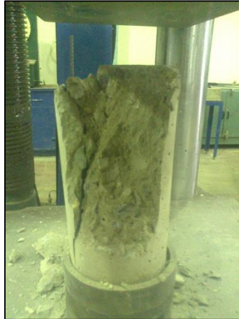
Figura 3.26 Falla que Presentaron los Cilindros
