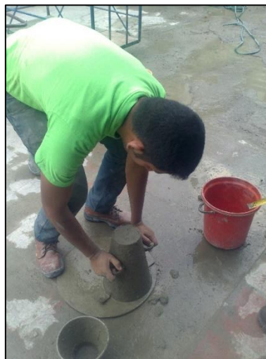
Figura 3.19 Medición de Asentamiento por Cono de Abrams
