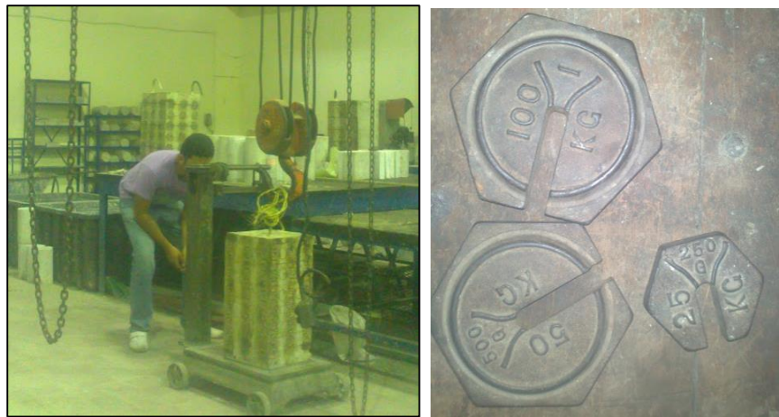
Figura 3.24 Pesaje de Elementos utilizando Romana
