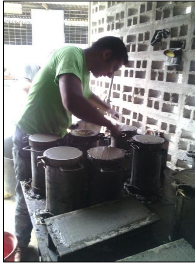
Figura 3.21 Vaciado de Cilindros
