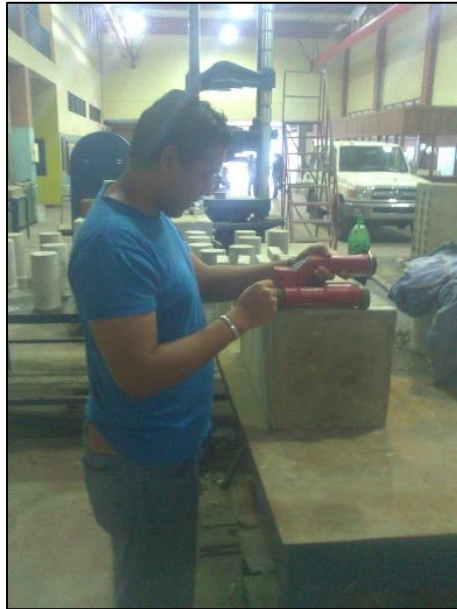
Figura 3.29 Ensayo Electromagnético (Ferroskan)
