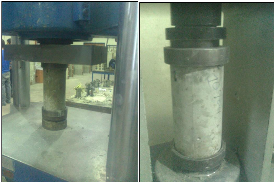
Figura 3.25 Ensayo de Resistencia a Compresión
