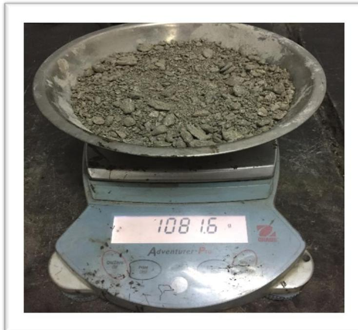
**Imagen III-5** Arena Lavada en estado seco.
