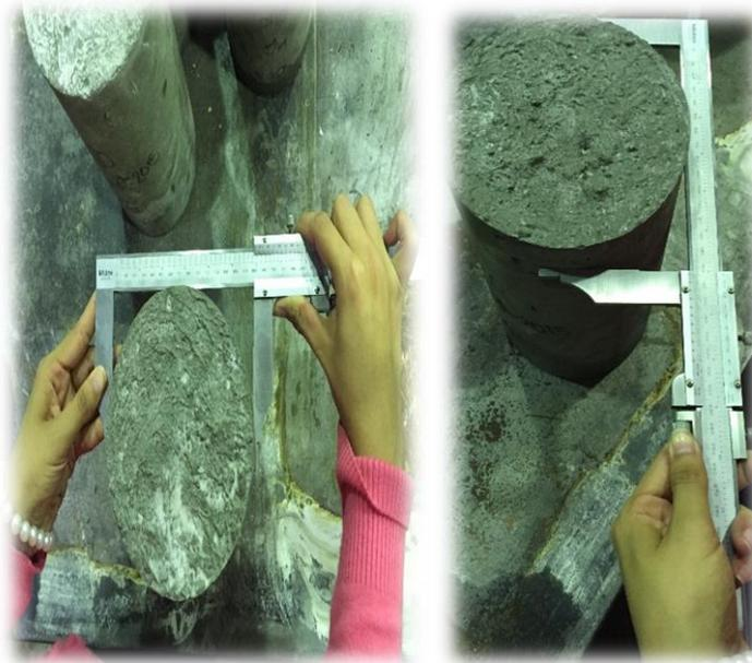
**Imagen III-55.** Medición de los diámetros de la probeta.
