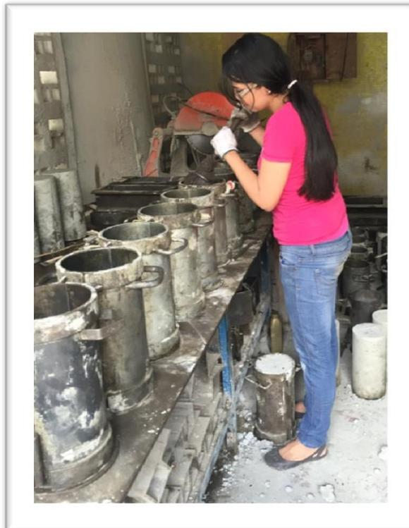
**Imagen III-47.** Proceso de lubricación de las conchas cilíndricas.
