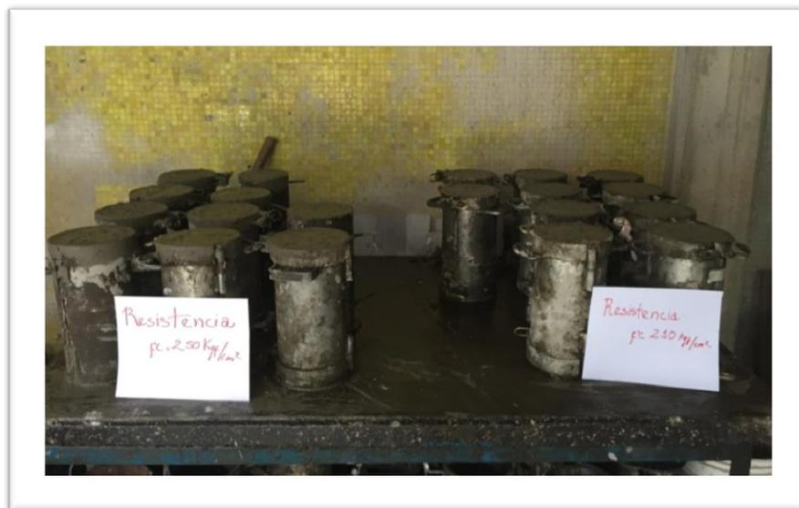
**Imagen III-49.** Colocación de las probetas cilíndricas enrasadas en la mesa de trabajo.
