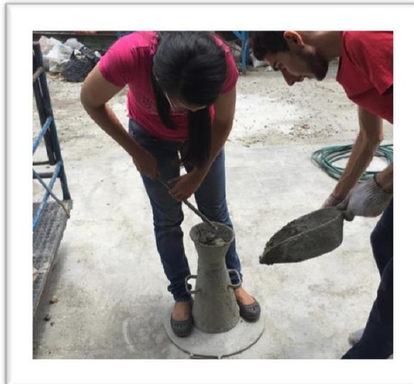
**Imagen III-43.** Proceso de compactación de la mezcla de concreto.
