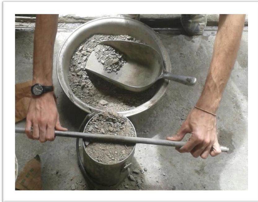
**Imagen III-25** Llenado y enrasado con arena lavada en estado suelto.
