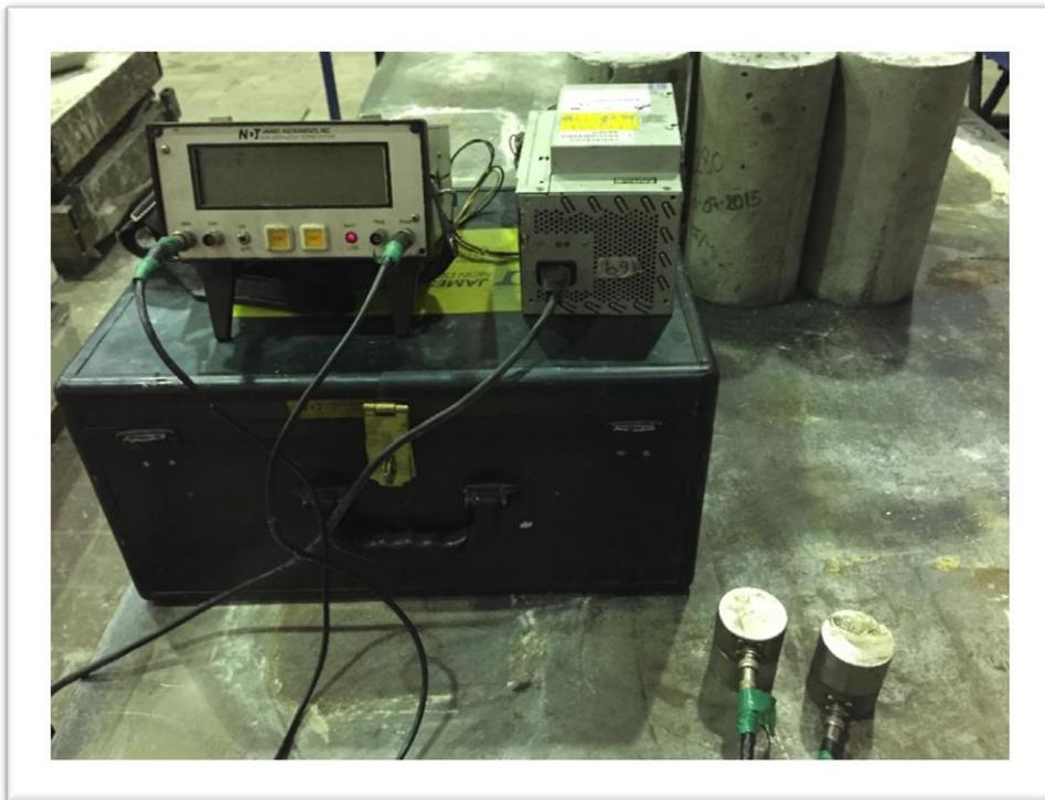
**Imagen III-58.** Máquina de Pulso Ultrasónico, NDT James Instruments INC.
