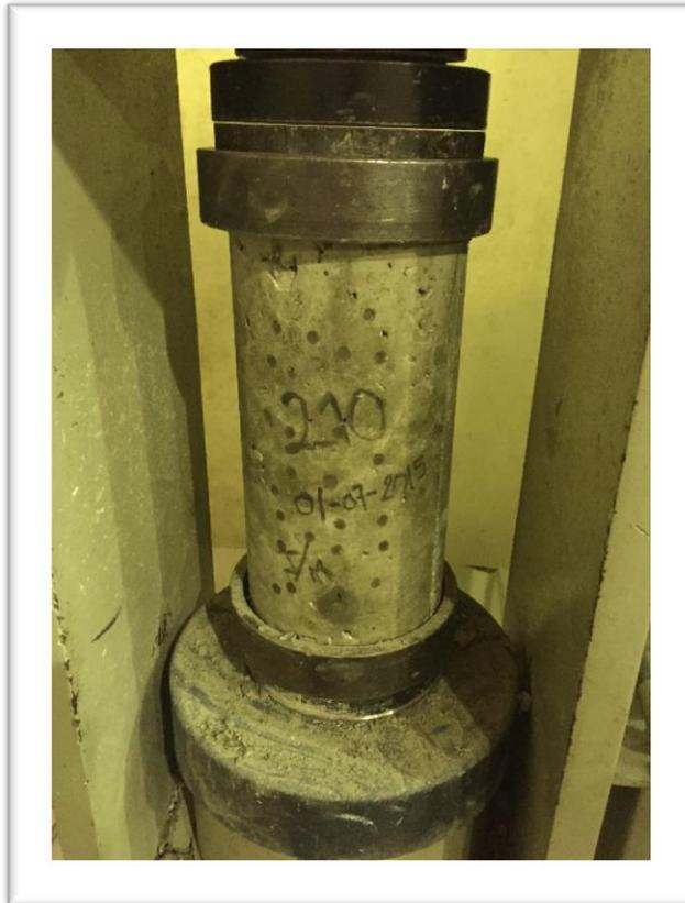
**Imagen III-63.** Marcado de 20 puntos con distancia entre ellos de 2 a 3cm.
