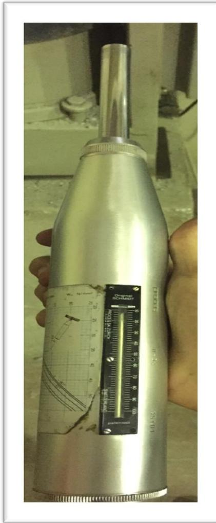
**Imagen III-62.** Esclerómetro.
