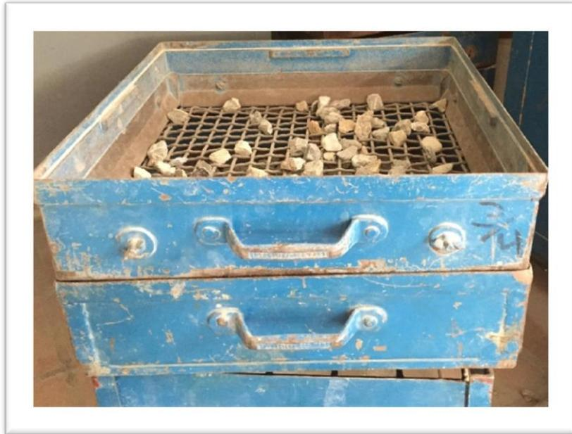
**Imagen III-12.** Tamizado del agregado grueso por el tamiz  $\frac{3}{4}$ "
