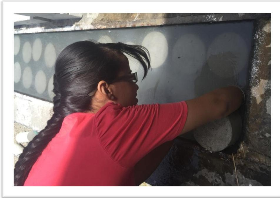
**Imagen III-52.** Colocación de las probetas cilíndricas en la piscina de curado.
