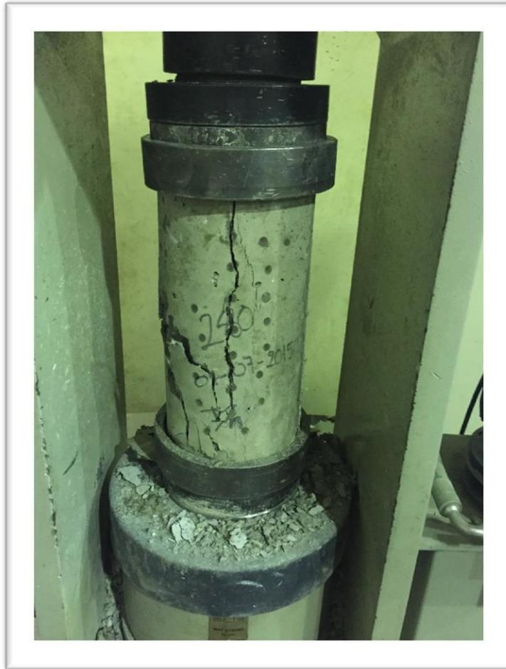
**Imagen III-66.** Aplicación de la fuerza a compresión hasta lograr la falla del cilindro.
