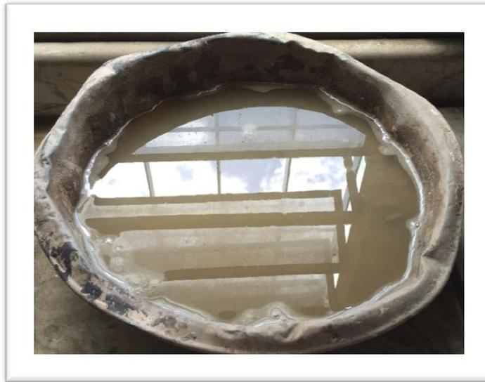
**Imagen III-17** Arena lavada sumergida en agua durante 24 horas.
