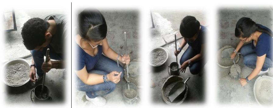
**Imagen III-27** Compactación por medio de 3 capas y enrasado de la arena lavada.
