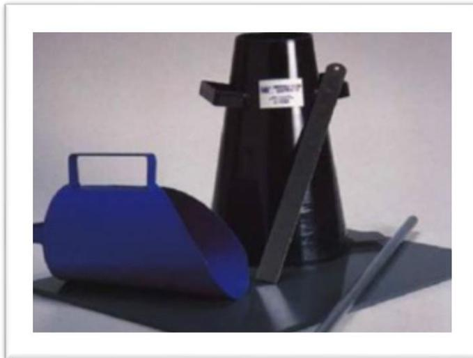
Imagen II-1. Instrumentos usados para realizar el ensayo de asentamiento.
