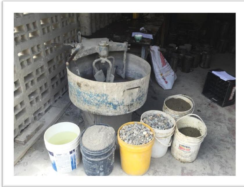
**Imagen III-39.** Mezcladora de concreto de eje vertical y componentes de la mezcla.
