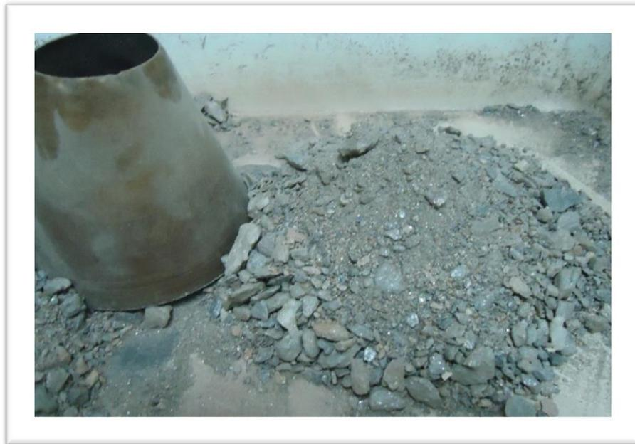
**Imagen III-19** Muestra ya alcanzada la condición de saturado con superficie seca.
