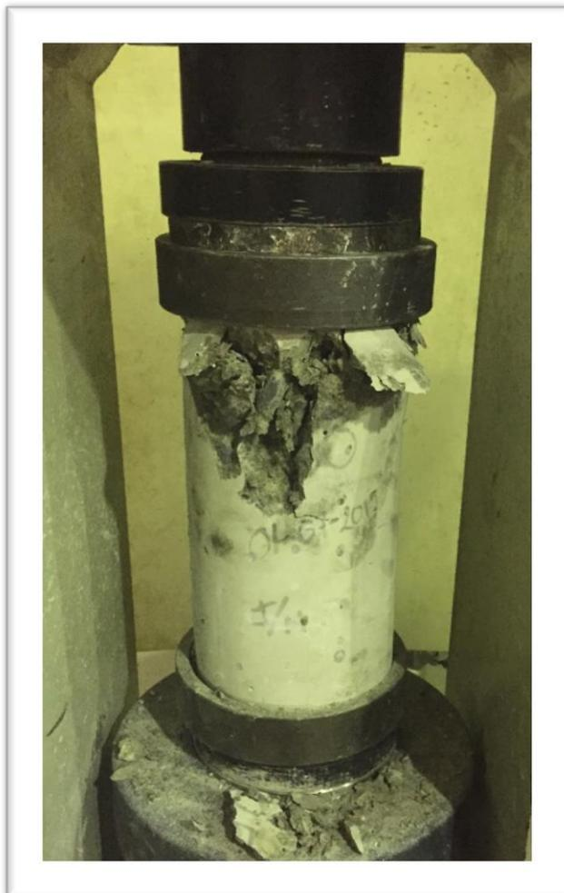
Falla por fractura del agregado.
