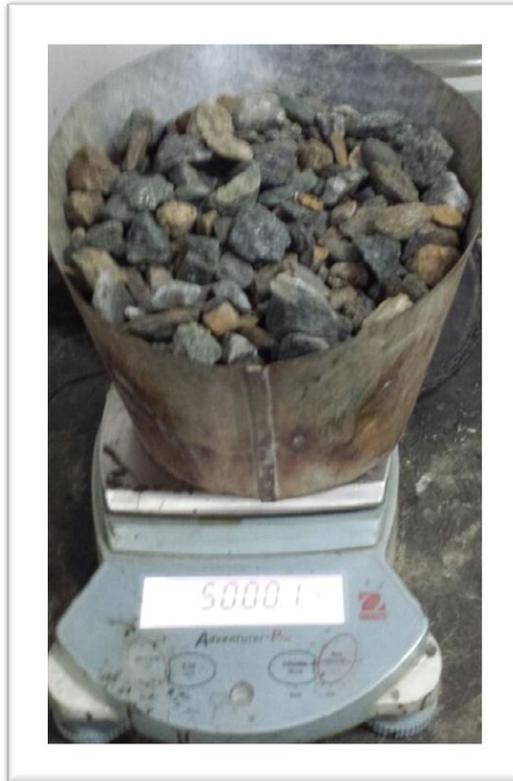
**Imagen III-23** Peso de la muestra saturado con superficie seca.
