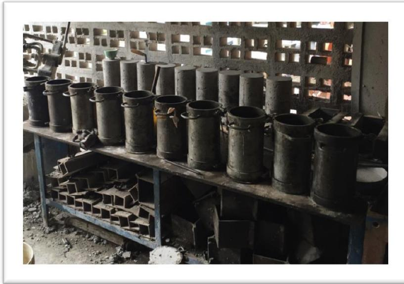
**Imagen III-46.** Disposición de las conchas cilíndricas sobre la mesa de trabajo.
