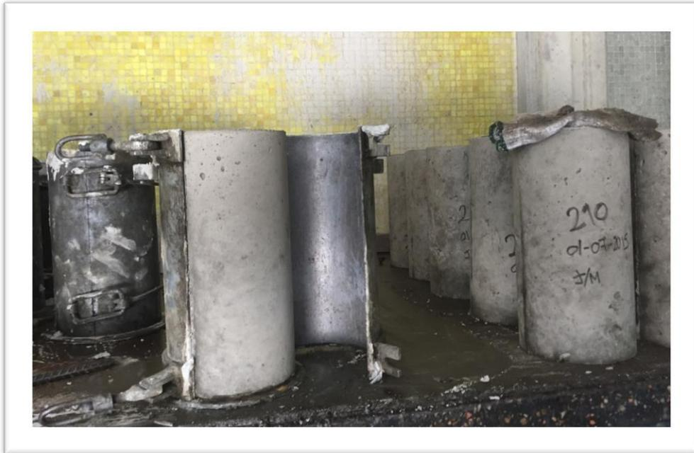
**Imagen III-50.** Desencofrado de los cilindros de concreto.
