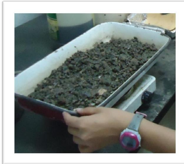
**Imagen III-18** Secado superficial del material por medio de la estufa.
