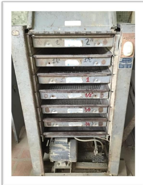
**Imagen III-11** Cernidora modelo Gilson Screen del agregado grueso.
