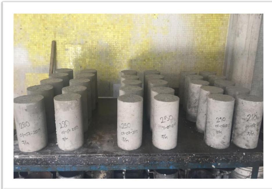
**Imagen III-51.** Probetas cilíndricas desencofradas e identificadas.
