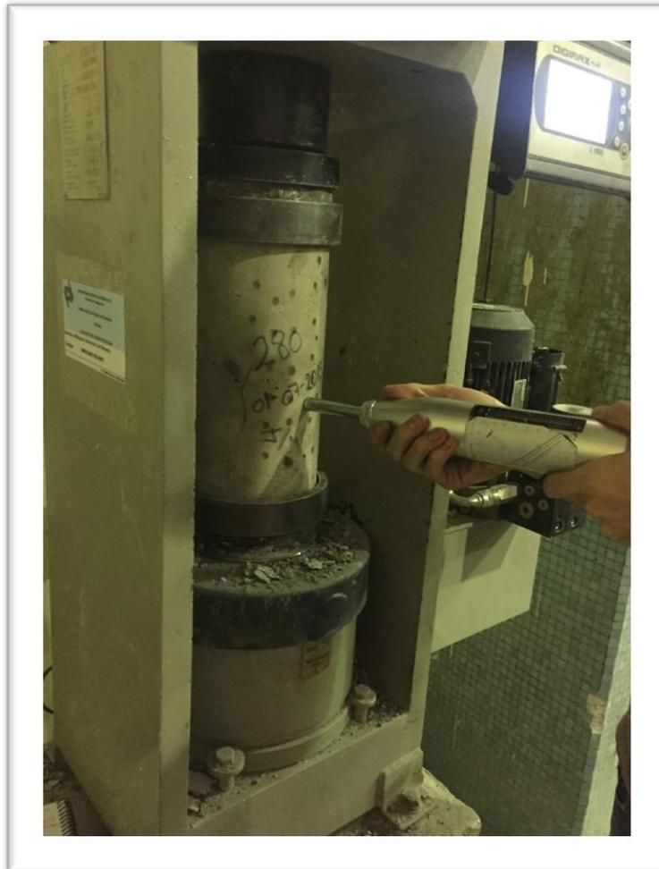
**Imagen III-64.** Misma inclinación del esclerómetro sobre el cilindro para cada punto.
