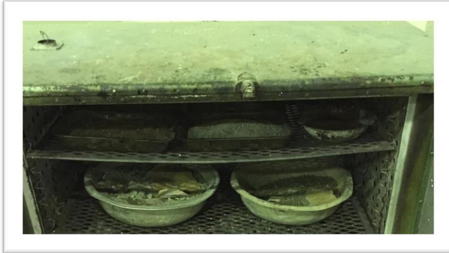
**Imagen III-31** Secado por 24 horas de 2Kg de arena lavada.
