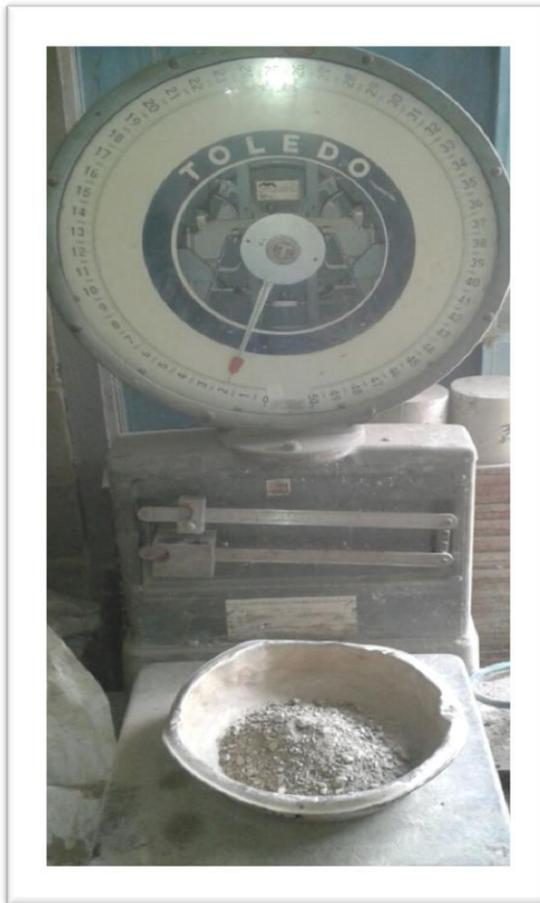
**Imagen III-32** Peso de la arena lavada seca luego de transcurrido las 24 horas.
