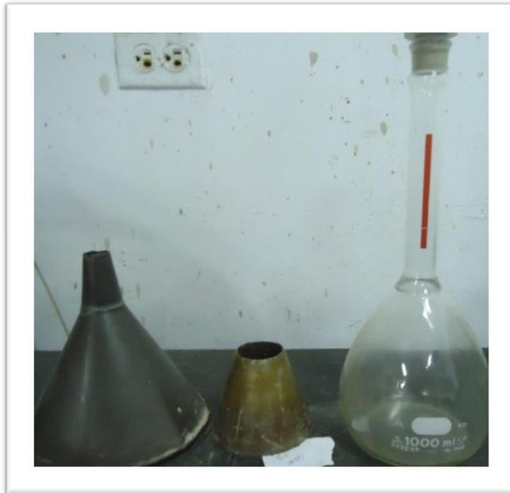
**Imagen III-16** Instrumentos a utilizar en el ensayo de densidad y absorción del agregado fino.
