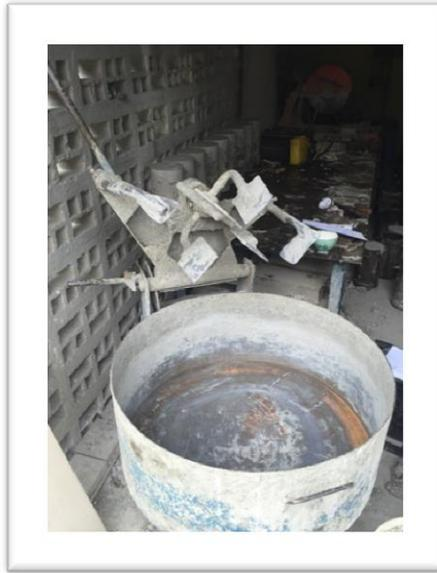
**Imagen III-35.** Mezcladora de concreto de eje vertical.
