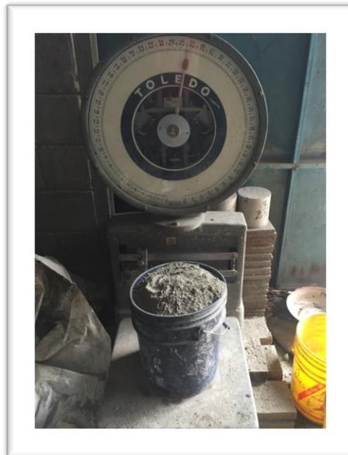
**Imagen III-36.** Pesaje del cemento Portland Escoria en la balanza de apreciación 500g.
