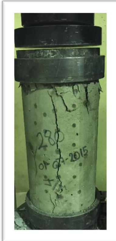
**Imagen III-65.** Colocación de un disco en la cara superior para garantizar la distribución uniforme.
