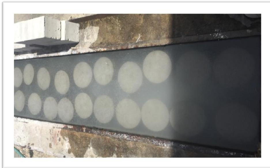
**Imagen III-53.** Probetas cilíndricas sumergidas en agua saturada de cal.
