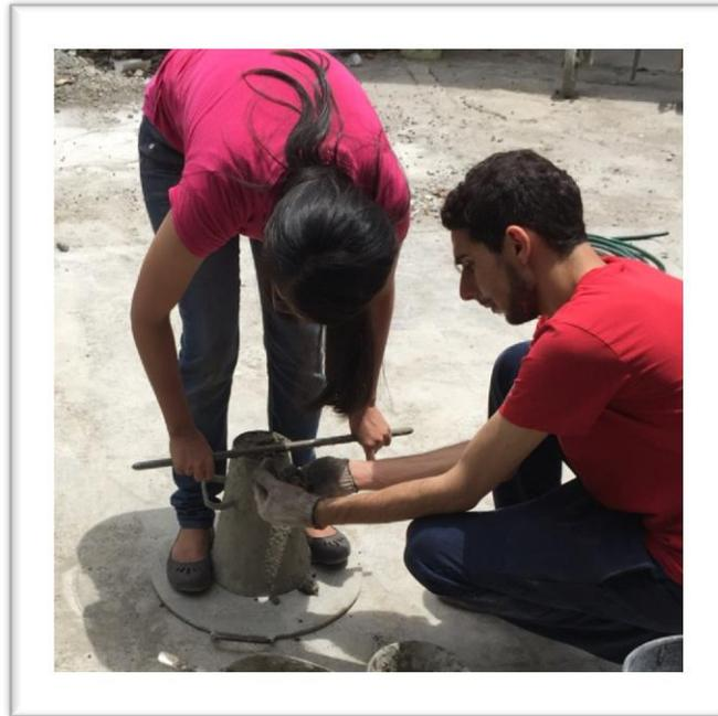
**Imagen III-44.** Proceso de enrasado de la mezcla de concreto.
