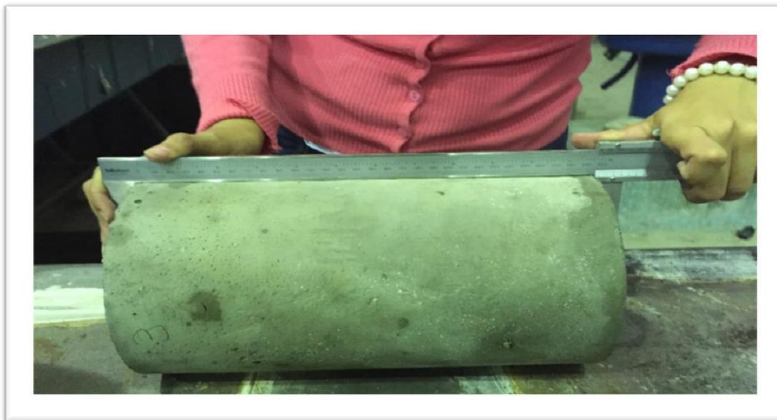
**Imagen III-56.** Medición de la altura de la probeta.
