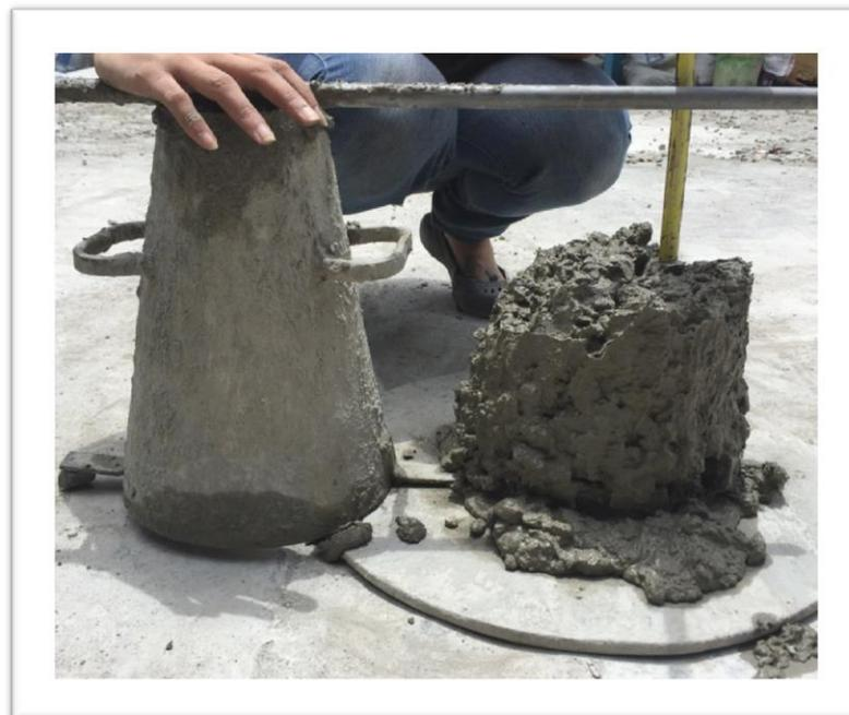
**Imagen III-45.** Medición del asentamiento de la mezcla de concreto.
