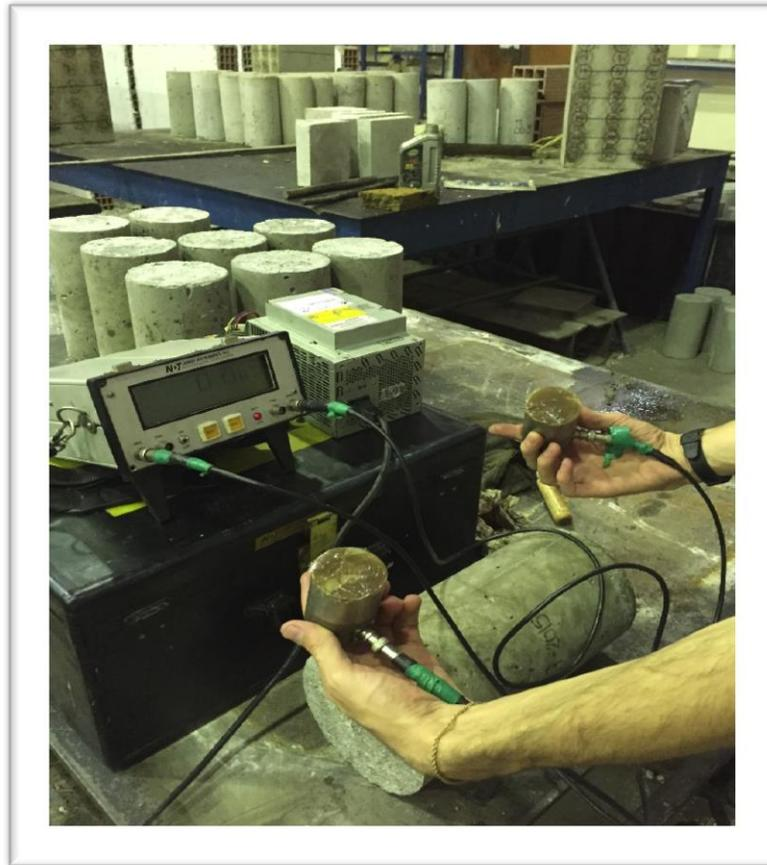
**Imagen III-59.** Lubricación de transductores con vaselina.
