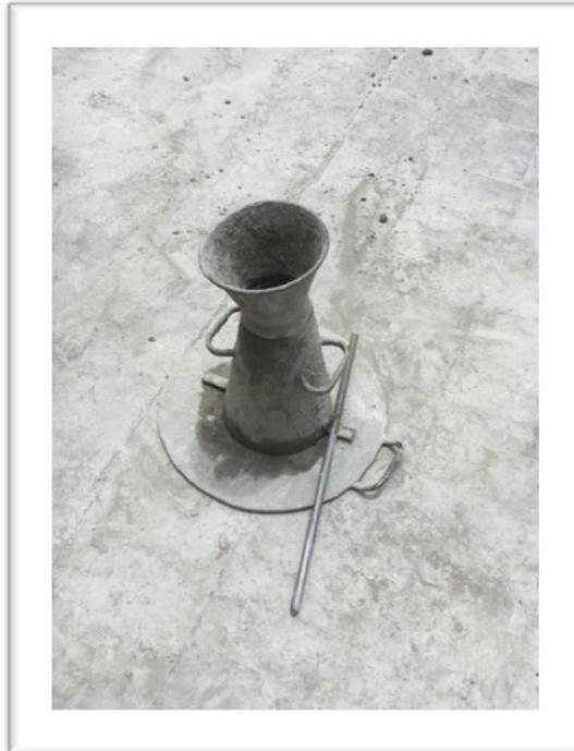
**Imagen III-42.** Materiales usados para realizar el ensayo del Cono de Abrams:
