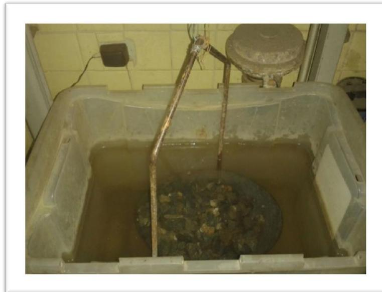
**Imagen III-24** Peso sumergido de la muestra de 500gr.
