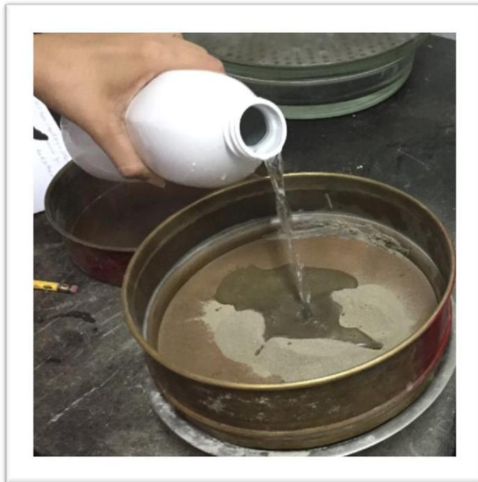
**Imagen III-7** Lavado de la muestra sobre el tamiz #200.
