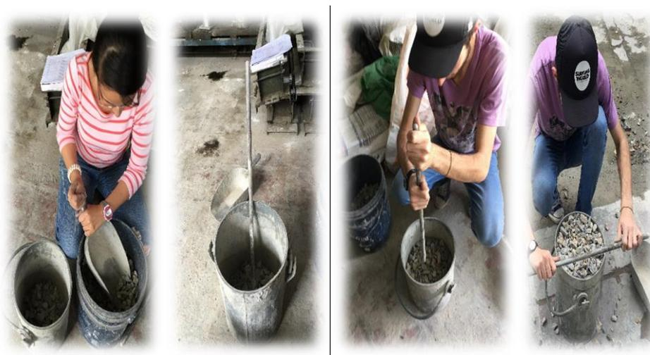
**Imagen III-30** Compactación por medio de 3 capas y enrasado de la arena lavada.
