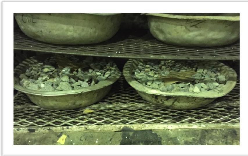
**Imagen III-33** Secado por 24 horas de 20Kg de piedra picada.
