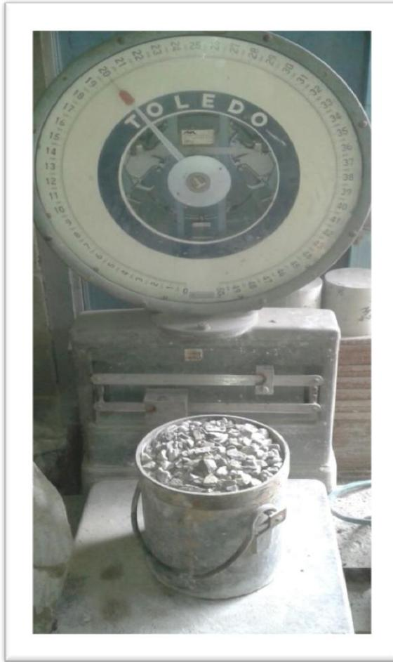
**Imagen III-29** Peso de la piedra picada en estado suelto.
