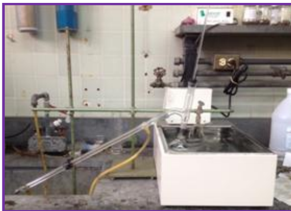
Figura N° 14°. Montaje utilizado para la recuperación del solvente. (Fuente propia)
