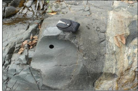
Figura D.58. Gneis, en donde se ve una abertura, posiblemente una toma antigua de núcleo.
