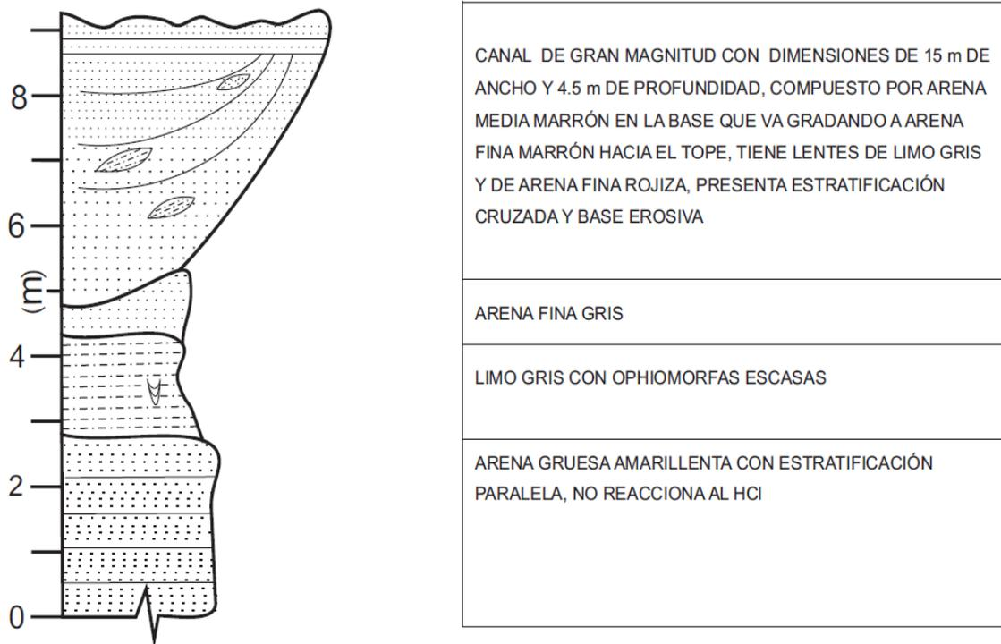
Fig. 4.23. Columna estratigráfica y descripción litológica de la sección aflorante en la Localidad 9 (LOC-9).
