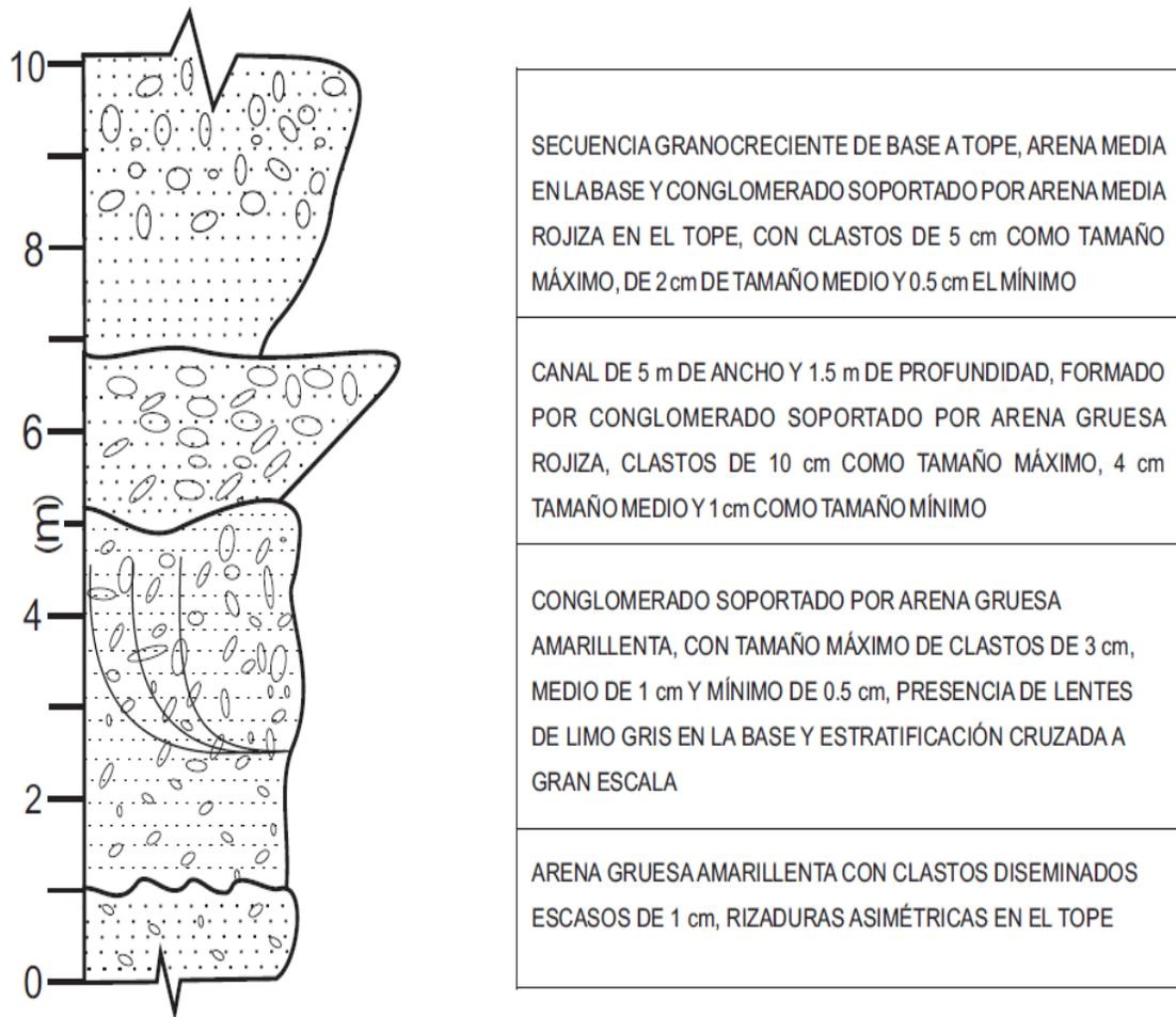
**Fig. 4.30.** Columna estratigráfica y descripción litológica de la sección aflorante en la Localidad 12 (LOC-12).
