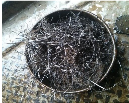
Figura N° 21: Partículas magnéticas generadas durante la realización de un sidetrack
