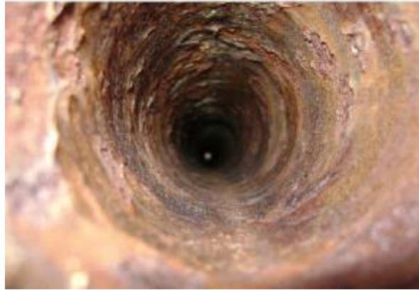
Figura N° 3: Corrosión interna de tuberías de perforación (Schlumberger, 2011)
