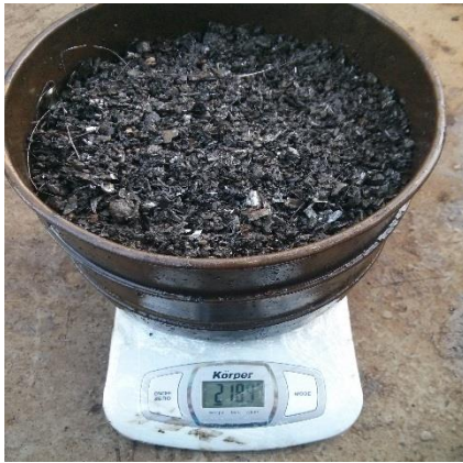
Figura N° 14: Determinación de la masa de partículas magnéticas
