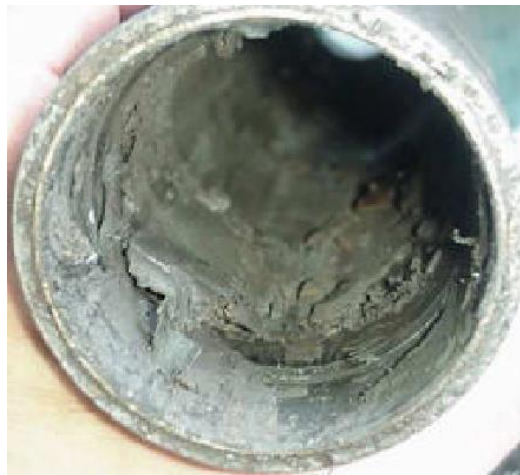
Figura N° 2: Partículas metálicas alojadas en el Torquer del PowerDrive (Schlumberger, 2011)
