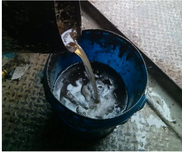
Figura N° 12: Dilución de una muestra con gasoil
