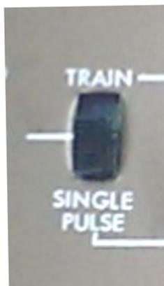
Figura 2.8: Switch para cambiar entre el modo de pulso simple o tren de pulsos
