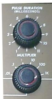
Figura 2.9: Perillas para ajustar parámetros del Ortec 4710
