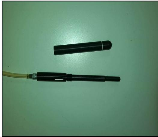
Figura 4.5: Cámara de ionización STANDARD IMAGING, tipo Farmer, modelo A19, serial SN XAQ103021.
