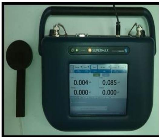
Figura 3.1: Patrón secundario de mamografía. Cámara de ionización plano paralela STANDARD IMAGING, modelo A650, serial SN D092301 y electrómetro STANDARD IMAGING, modelo SUPERMAX, serial P102731.
