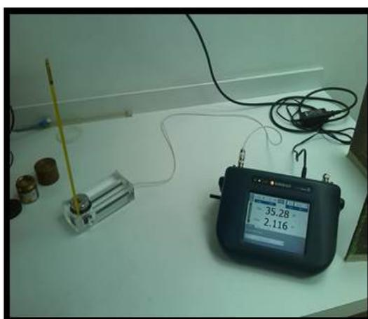
Figura 3.2: Montaje de control de estabilidad del patrón secundario de mamografía.
