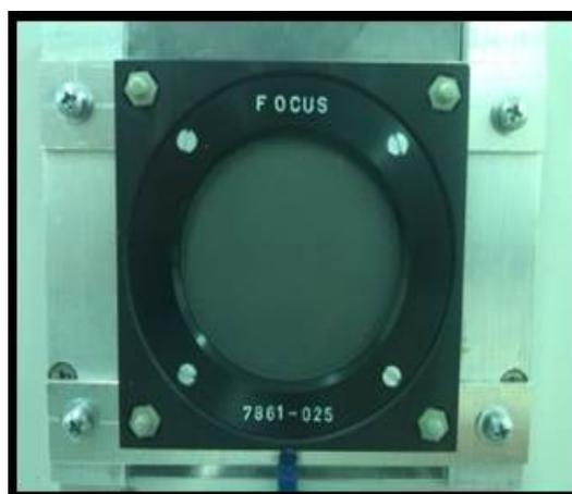
Figura 3.5: Cámara monitor marca PTW modelo 7861-025.
