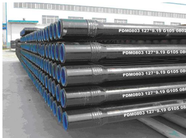
Figura 2.18. Tubería de perforación.
