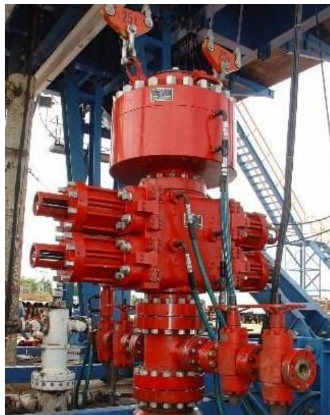
Figura 2.17. Válvulas Impidireventones o Blow Out Preventer “BOP.” Fuente: www.img.weiku.com .
