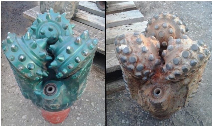
Figura 2.20. Representación de una mecha de perforación tricónica de insertos, tanto nueva como luego de su vida útil.
