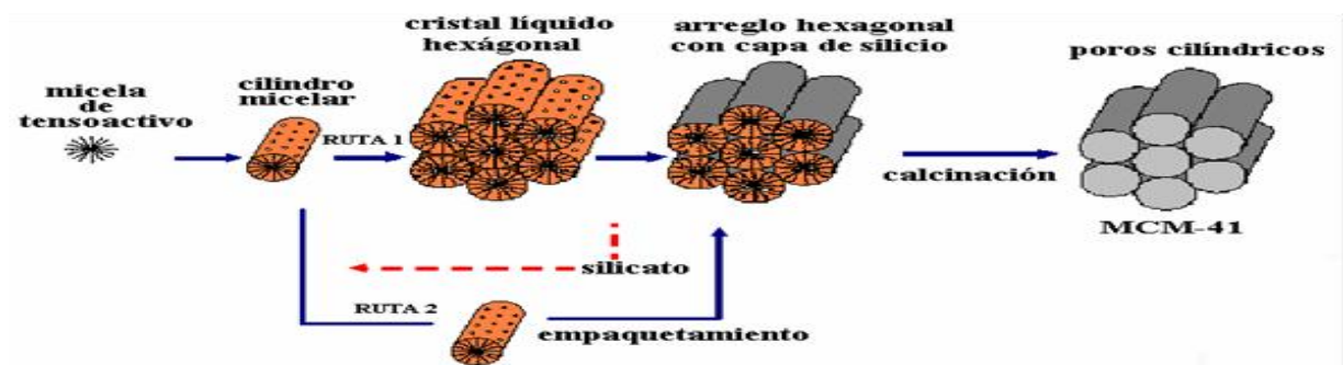
Figura 1: Representación de la formación del sólido mesoporoso MCM-41 [5] .
