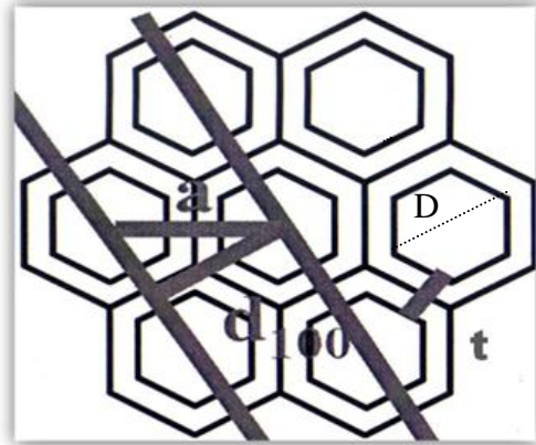
Figura 7: Representación esquemática de una celda hexagonal [5] .
