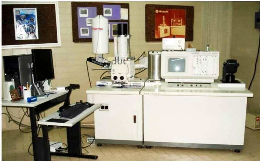
Figura 10: Microscopio Electrónico de Barrido modelo S-2400.
