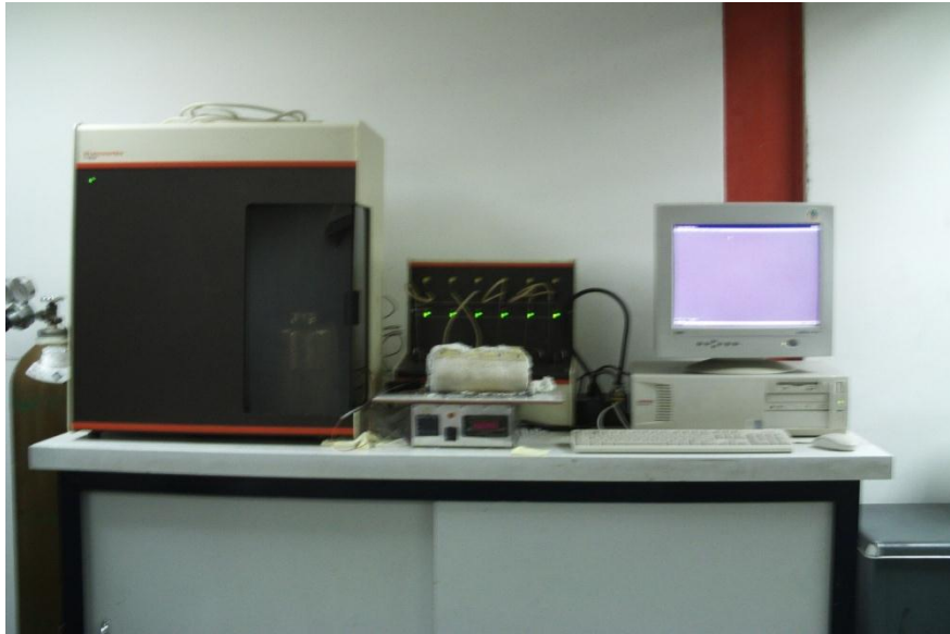
Figura 8: Equipo de adsorción marca Micromeritic, modelo Tristar 3000.
