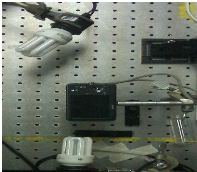
Figura 25. Adaptación de luces blancas
