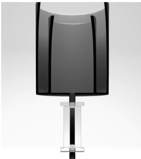
**Figura N° 13: Esquema digital del sistema formado por el tanque de mezclado y rebose con celda de campo eléctrico. (Elaboración propia)**
