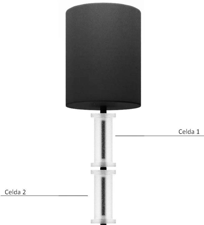
**Figura N° 25: Esquema del montaje variando el tiempo de residencia aplicando campo magnético con dos celdas en serie. (Elaboración propia)**
