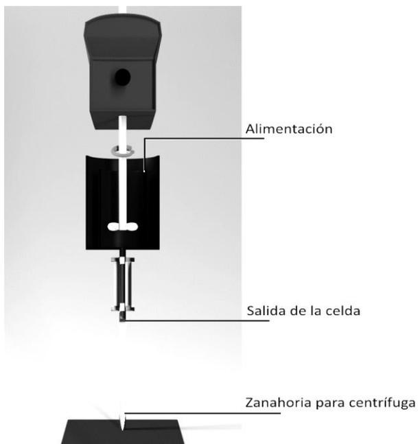
**Figura N° 20: Esquema del montaje con puntos de obtención de muestras. (Elaboración propia)**
