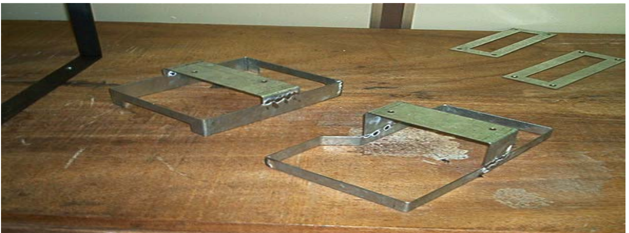
Figura 3.5 Soportes de los aparatos de comprobación (centro)
