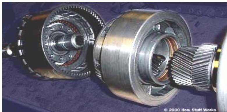
Figura 2.4 Grupo de engranajes planetarios ( www.howstuffworks.com ).
