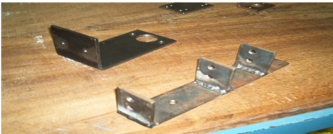
Figura 3.1 Base de Electroválvulas (der.)
