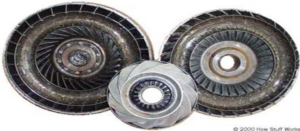
Figura 2.3 Turbina (izq.), estator (centro) y bomba (der.)
