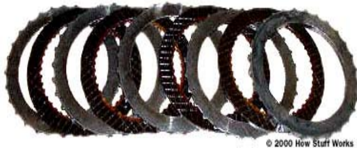
Figura 2.7 Conjunto de placas de fricción y placas conducidas de un embrague de placas (www.howstuffworks.com).
