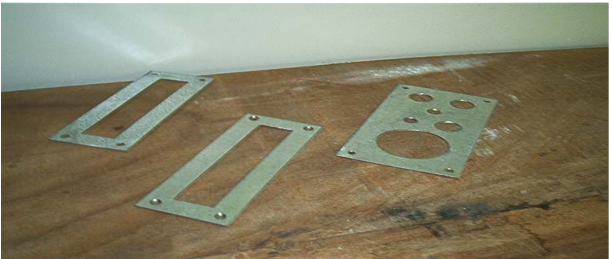
Figura 3.4 Bases de los teclados (der.) y el panel de indicadores e interruptores (izq.)
