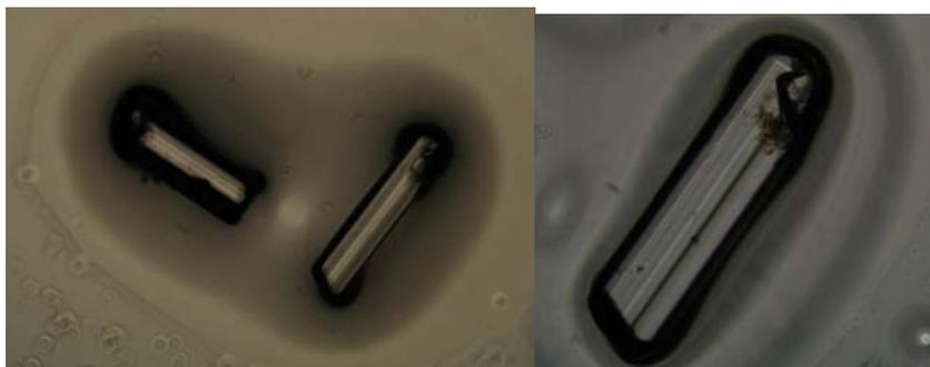
**Figura 34.** Cristales de sal del buffer recuperados en el agua de rompimiento del tratamiento con la mezcla de LiPp (50X de aumento).
