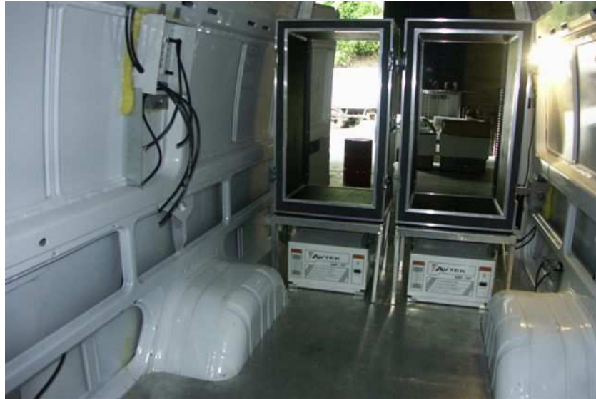
Fig. 31. Ubicación de los Reguladores de Voltaje.
