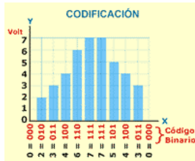
Fig.10. Codificación de la señal en código binario
