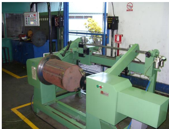
Figura N° 19. Vista de la máquina soldadora de tanque de transformadores
