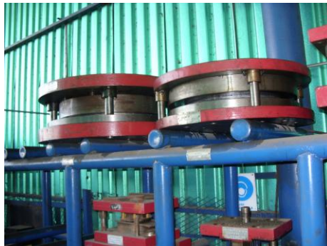
Figura N° 3. Troquel para darle forma al disco
