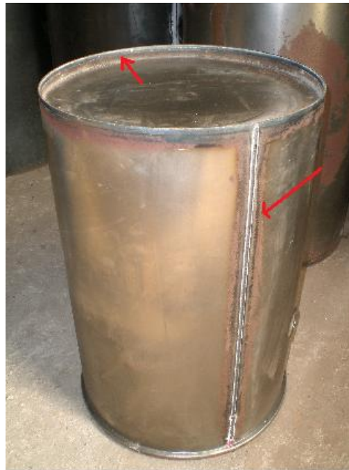
Figura N° 37. Tanque ya soldado
