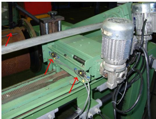
Figura N° 33. Posición de la antorcha sobre el tanque y microswitches n6 y n7
