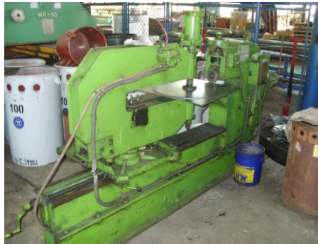
Figura N° 2. Máquina cortadora circular
