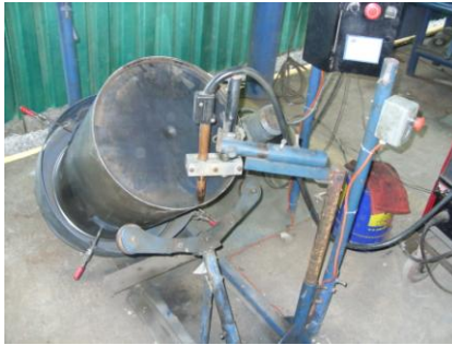
Figura N° 10. Máquina de soldadura circular para el fondo del tanque
