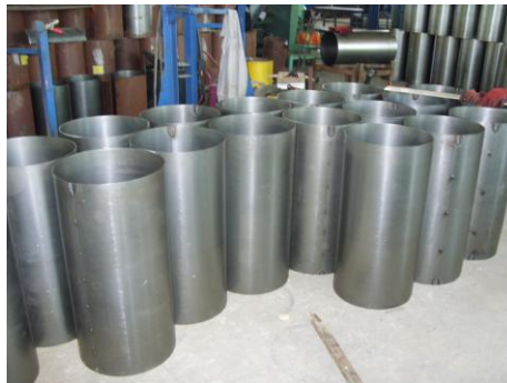
Figura N° 6. Cilindros punteados con soldadura
