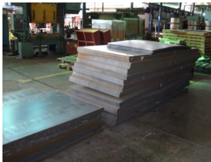
Figura N° 1. Láminas de hierro cortadas para el cuerpo y fondo del tanque.
