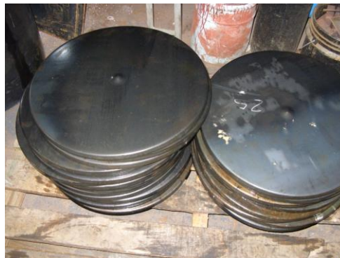
Figura N° 4. Fondo de los tanques
