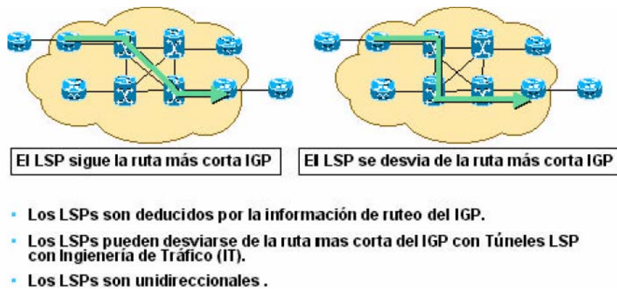
Figura 2-10. Esquema de funcionamiento de LSP FUENTE: Juniper Network. (2000): "Multiprotocol Label Switching"
