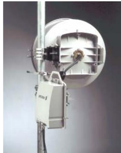
**Figura 31. Unidad de Radio separada de la antena**
