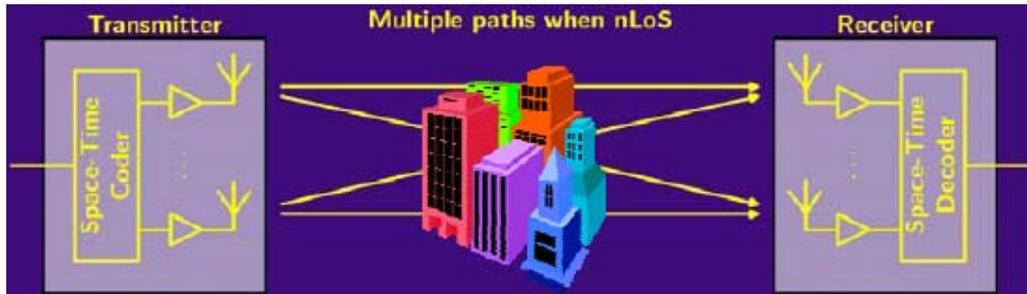
Figura 50. Multitrayectoria del Sistema Canopy.
