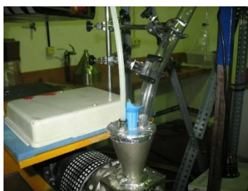
Figura 3.3. Pieza de Polipropileno mecanizada con boquillas de entrada para el Joncryn 4300-F, el PLA y el Nitrógeno (Fuente: elaboración propia, 2014).
