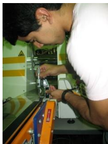
Figura 3.12. Medición del espesor de la lámina de PLA con la utilización de un micrómetro (Fuente: elaboración propia, 2014)
