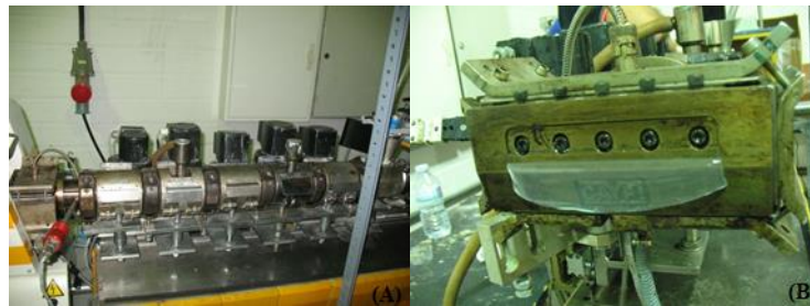
Figura A.19. Extrusora Doble Husillo Collin (A) y Cabezal Plano de la Extrusora (B).
