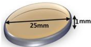
Figura 3.19. Dimensión y geometría de las Probetas para los ensayos reológicos.
