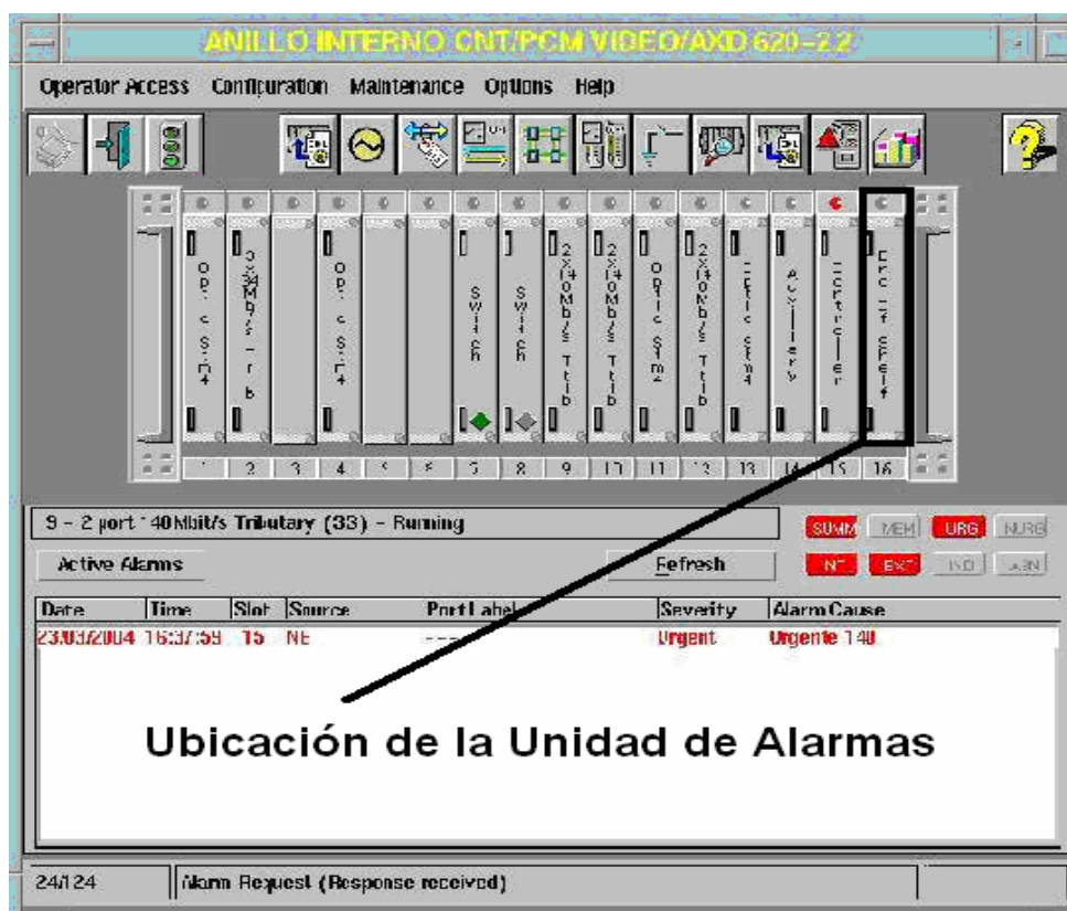
Figura 5.7. Disposición de la Unidad de Extensión de Alarmas y EOW dentro del EM.
