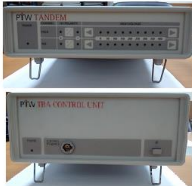
Fig. 3.9. Electrómetro para dosimetría absoluta TANDEM de la PTW.
