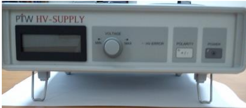
Fig. 3.10. Fuente externa de alto voltaje de la PTW.
