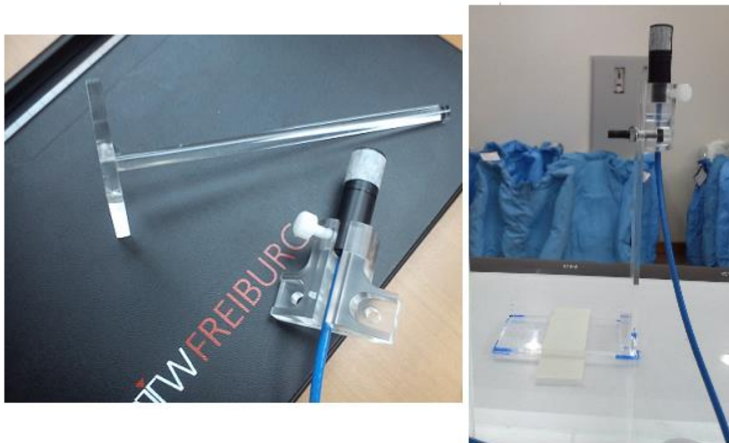
Fig. 3.6. Cámara líquida 30018 microLion de la URO GURVE.
