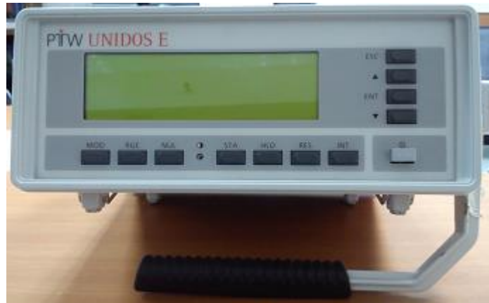
Fig. 3.8. Electrómetro. Modelo: UNIDOS E de la PTW.
