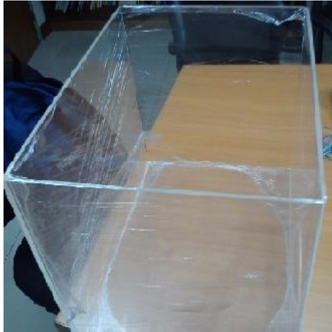
Fig. 3.3. Tanque de paredes acrílicas.
