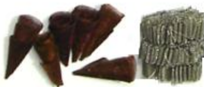
Fig. 6: Estructuras evaluadas (a) Conos (b) empaque metálico elaborado similar al comercial.
