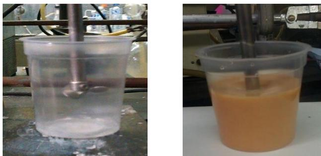
Figura N° 4 Reactor y agitador para el mezclado de los reactivos
