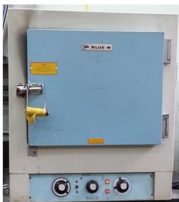
Figura N° 5 Medio de calentamiento para la cristalización (Estufa)
