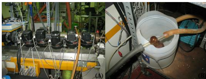
Figura 3.2. Manguera conectada a la segunda boquilla de escape de la extrusora (A) y sistema de condensación (B) para los gases de escape (Fuente: elaboración propia, 2014).
