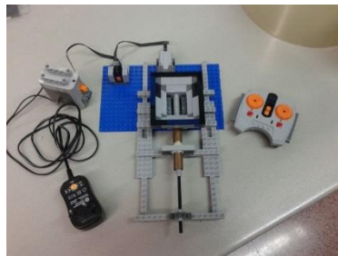
Figura A.27. Prototipo de Dosificación de Polvos para bajas cantidades másicas.
