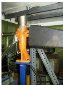
Figura 3.1. Boquilla de la tolva conectada al dosificador y este último a un tubo de goma para la circulación del material (Fuente: elaboración propia, 2014)
