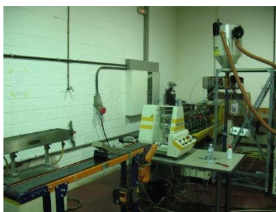
Figura 3.5. Vista frontal de la línea de proceso de extrusión reactiva (Fuente: elaboración propia, 2014)
