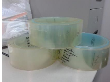
Figura 3.16. Láminas de PLA obtenidas durante el proceso de extrusión reactiva (una pura y dos modificadas estructuralmente) (Fuente: elaboración propia, 2014)
