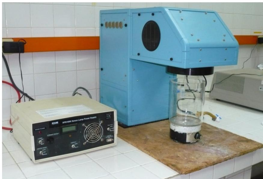
**Figura 8.** Imagen del Simulador Solar empleado en las degradaciones fotocatalíticas.
