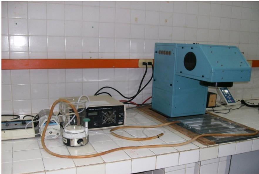
**Figura 9.** Imagen del Simulador Solar utilizado en las degradaciones fotocatalíticas empleando el reactor tubular de flujo continuo.
