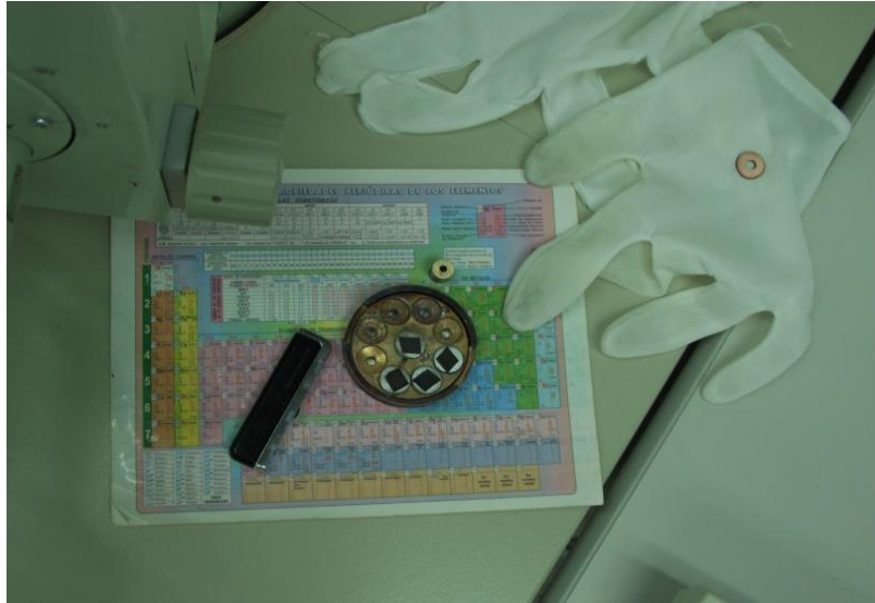
Figura 4.4.- Porta muestra sobre el cual son colocadas las muestras a analizar para realizar los estudios de SEM y EDX.
