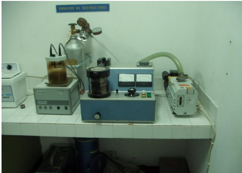
Figura 4.2.- Equipo mediante el cual se recubrió de oro la muestra, marca Esputerin Hochspannung.
