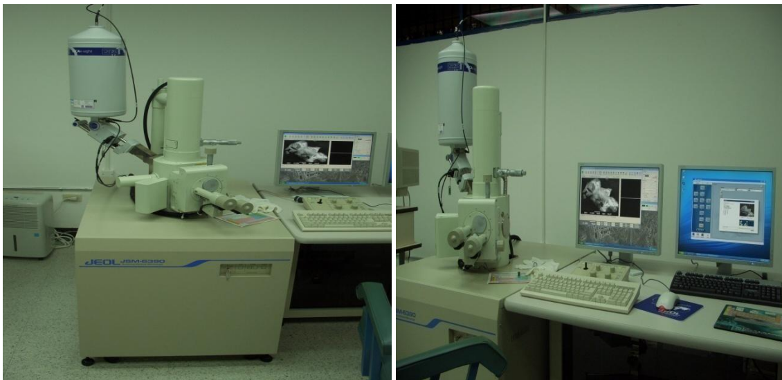
Figura 4.3.- Microscopio electrónico de barrido marca JEOL JSM – 6390 y sonda de rayos X Oxford Instruments, modelo 7582.
