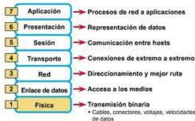
El encapsulamiento rodea los datos con la información de protocolo necesaria antes de que se una al tránsito de la red. Por lo tanto, a medida que los datos se desplazan a través de las capas del modelo OSI reciben encabezados, información final y otro tipo de información. Esto puede verse ejemplificado cuando un usuario de correo electrónico envía un mensaje, de la siguiente forma:
