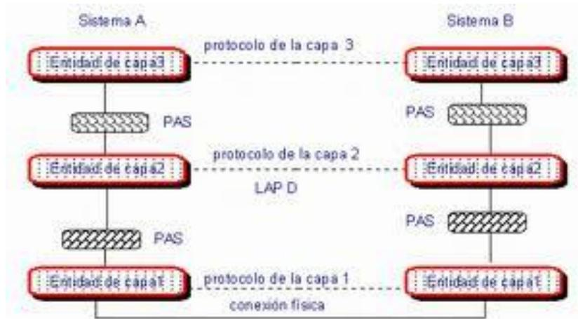
La **capa 1** define los parámetros eléctricos de la señal en la interfaz, la estructura de la trama y su temporización, la activación y desactivación de los terminales y el control de acceso a los terminales.
