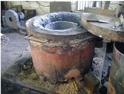
Fig. 3..2.2 Horno de Fundición
