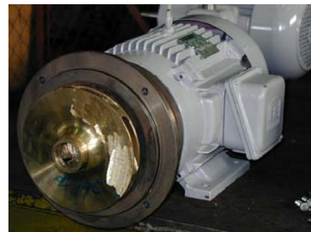
Fig. 3.5.5 Colocación del impulsor.
