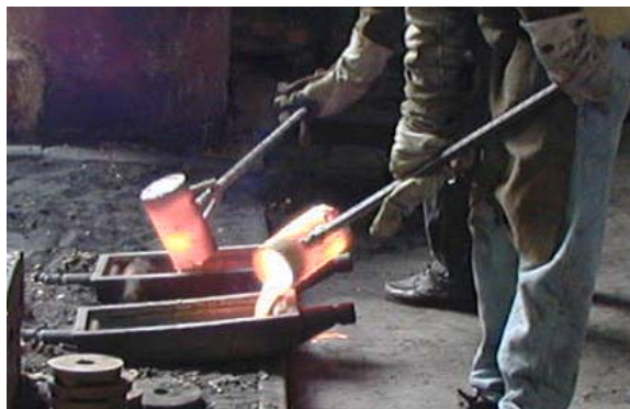
Fig. 3.2.6 Lingoteo de material de retorno
