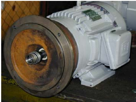
Fig. 3.5.4.a Colocación del Sello Mecánico
