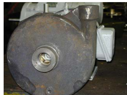
Fig. 3.5.6 Colocación de la carcasa
