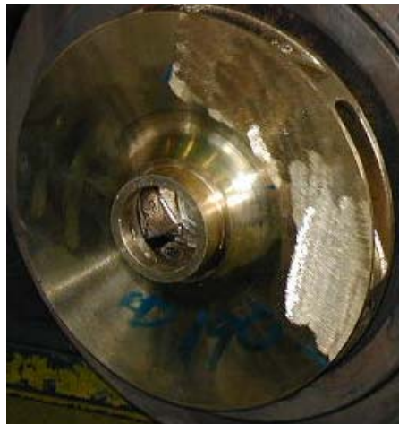
Fig. 3.4.11 Impulsor Mecanizado Estáticamente
