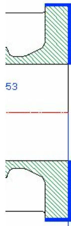
Fig.3.3.15 Brida de succión sobredimensionada
