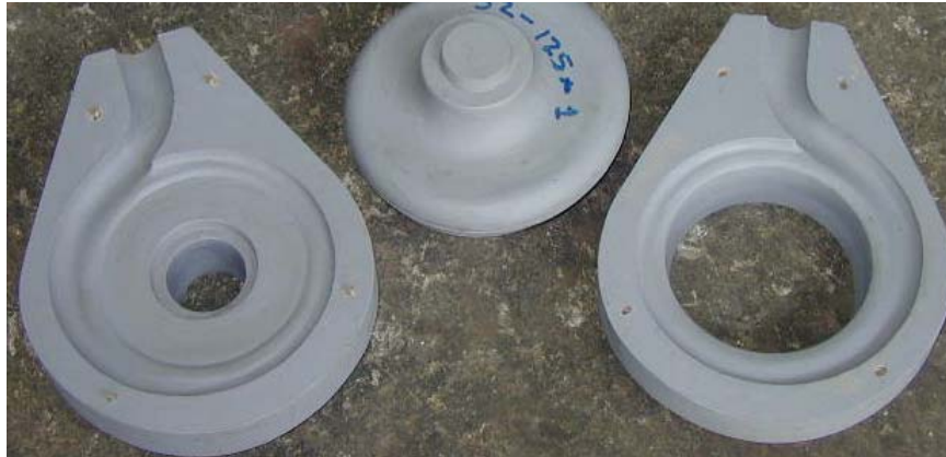
Fig.3.3.22 Caja de Macho para la Carcasa 32-125
