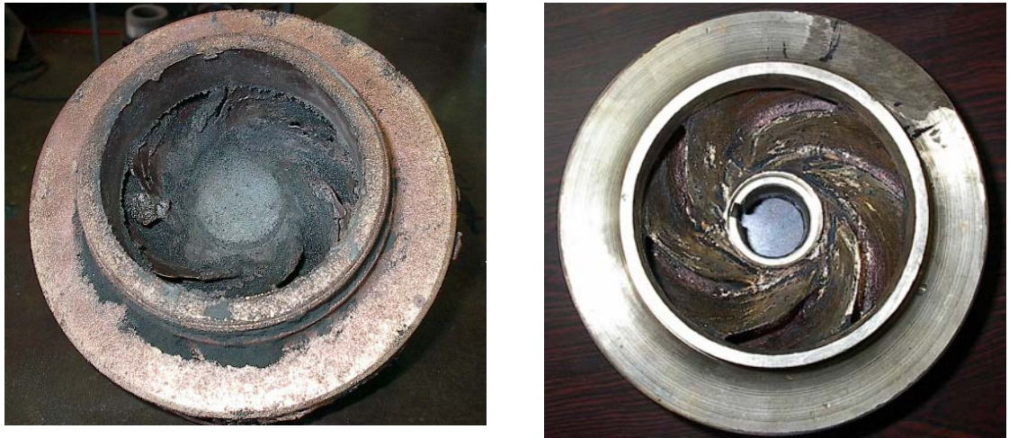
Fig. 3.4.1b Impulsor antes y después del Mecanizado
