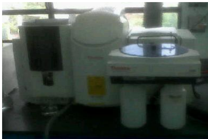
Fig. 16 Espectrómetro de absorción atómica, marca Thermo, modelo M Series
