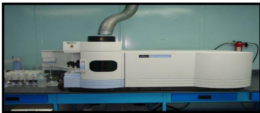
Fig. 15 Espectrómetro de emisión óptica con plasma inductivamente acoplado. Modelo Óptima 5300V. Perkin Elmer.
