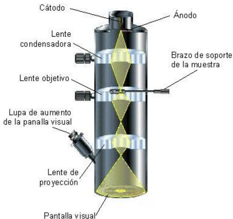
Figura 1-10: Esquema de un Microscopio Electrónico de Transmisión.
