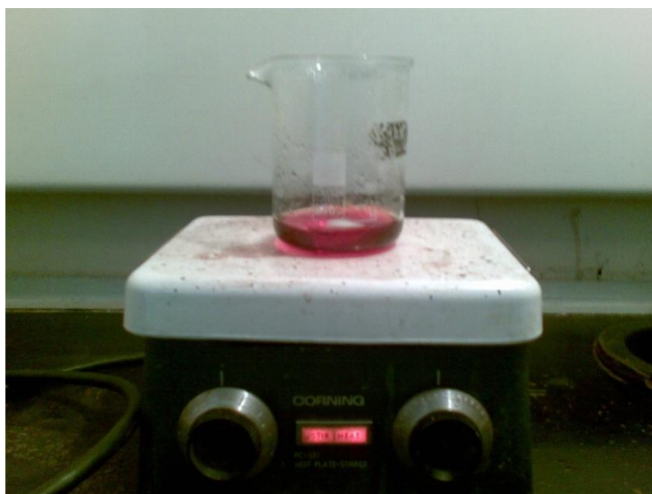
Figura 2-1: Proceso de mezcla de nitratos dentro de un beaker de 250ml, colocado sobre una plancha.
