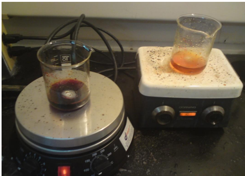
Figura 2-2: Agitación de los reactivos en las planchas (Sol-Gel).
