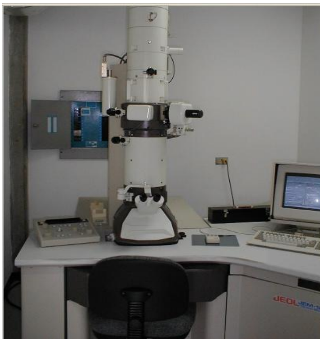
Figura 2-5: Equipo de Microscopía Electrónica de Transmisión, marca JEOL JEM 1220.
