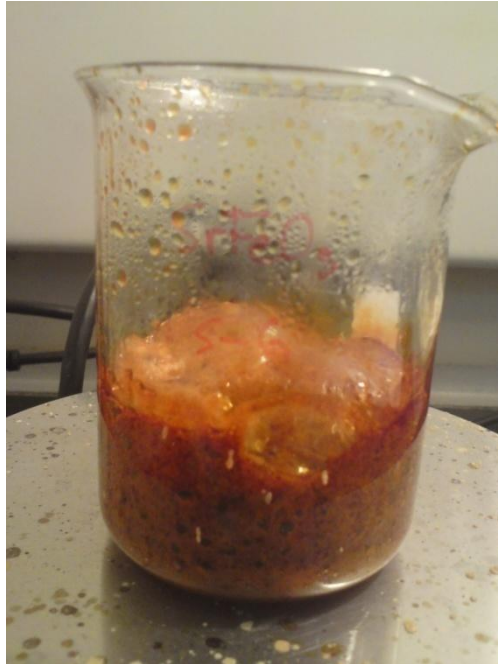
Figura 2-3: Resina amorfa resultante del proceso de Sol-Gel ( \text{SrFeO}_3 ).
