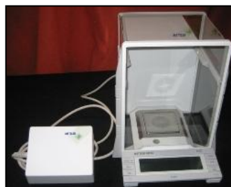
Modelo: Mettler Toledo AT201 Sensibilidad \pm 0,1\text{mg}
