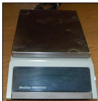
Modelo: Mettler Toledo PM3000 Sensibilidad \pm 0,01\text{g}
