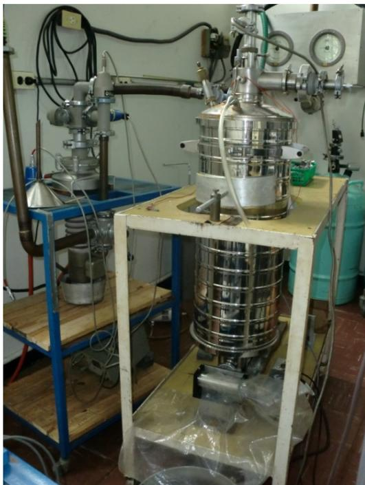
Figura 3.- Derecha.-Criostato utilizado para variar la temperatura de la muestra y vista posterior del detector de radiación gamma. Izquierda.- Sistema de vacío conectado al criostato.
