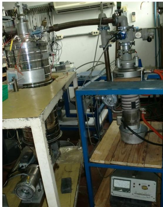
Figura 4.- Derecha.-Sistema de vacío conectado al criostato. Izquierda.- Criostato y fuente de movimiento Mössbauer.
