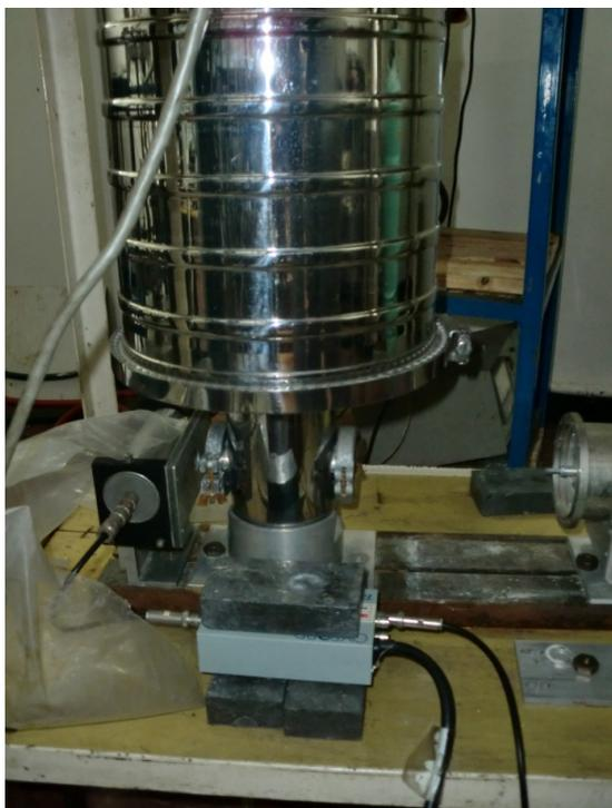
Figura 5.- Disposición geométrica de la muestra dentro del criostato con respecto la fuente Mössbauer y el detector de radiación para estudios a temperatura variable.
