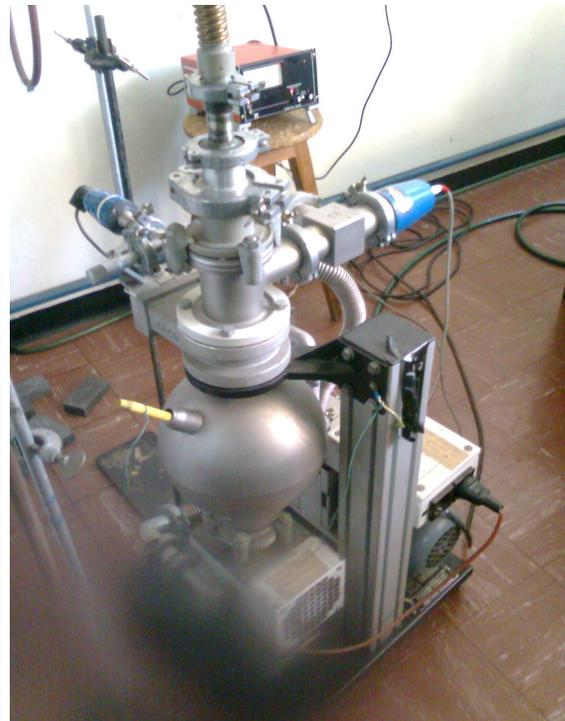
Figura 2.- Bomba mecánica y difusora utilizada en el encapsulado de la muestra en los tubos de cuarzo.
