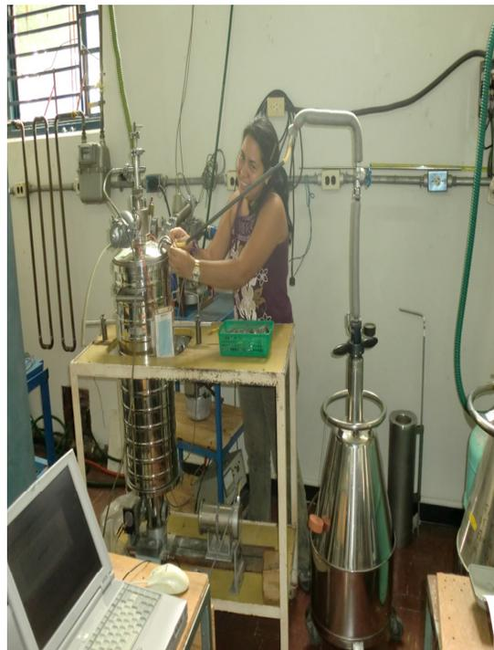
Figura 8.- Llenado de la cámara de nitrógeno del criostato.
