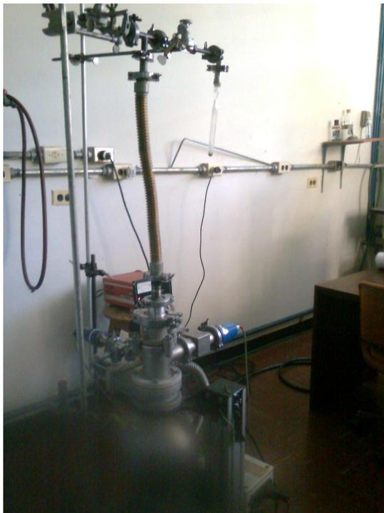
Figura 1.- Arreglo experimental para lograr alto vacío en los tubos de cuarzo, para su posterior sellado.
