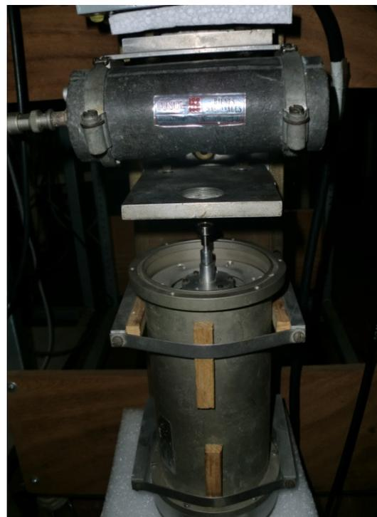
Figura 6.- Disposición geométrica de la muestra con respecto la fuente Mössbauer y el detector de radiación para estudios a temperatura ambiente.
