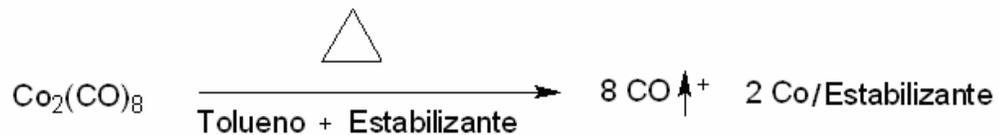
Ecuación I.2. Esquema de reacción para la termólisis de nanopartículas de cobalto<sup>3</sup>.
