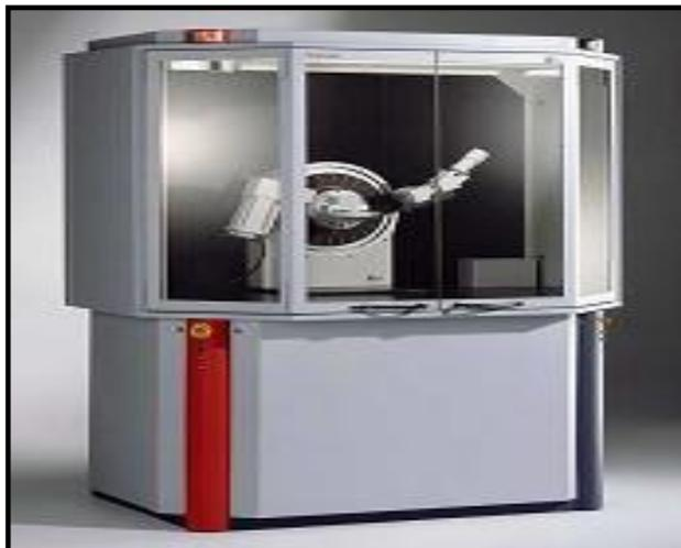
**Figura 16:** Equipo empleado para la Difracción de Rayos X.
