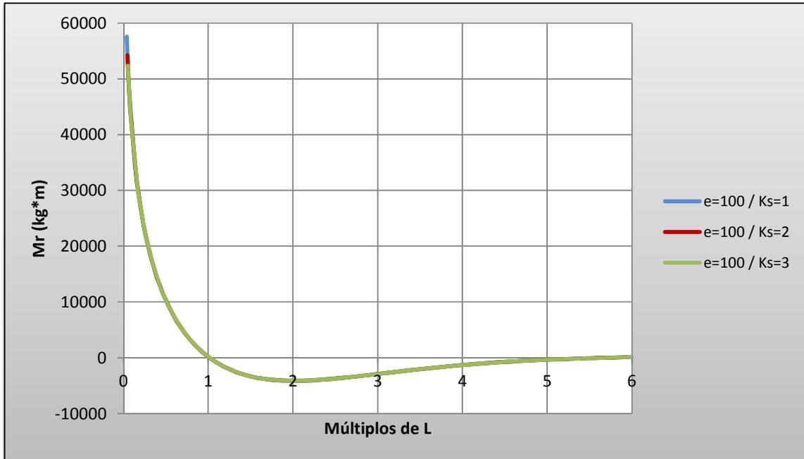
El comportamiento de las curvas de momento radial en función de los múltiplos de radio de rigidez efectiva es el mismo independientemente del módulo de reacción del suelo.
