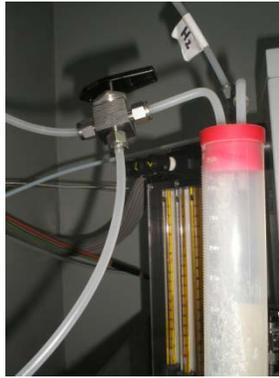
**Figura 21.** Burbujeador para saturación de Ar con vapor de agua
