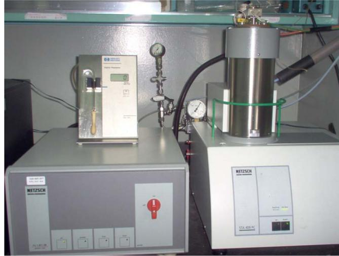
**Figura 20.** Termobalanza marca Netzsch, modelo STA 409PC/4/H/CO luxx
