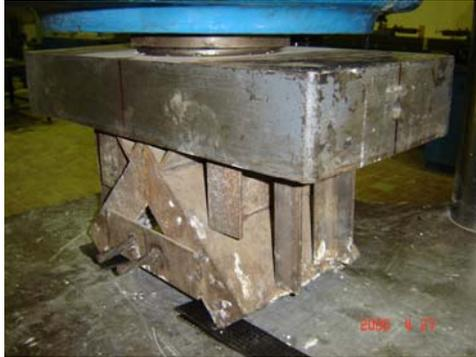
**Figura A8-9.** *Ángulo metálico superior de 90° colocado en plancha rígida rectangular rotulada*
