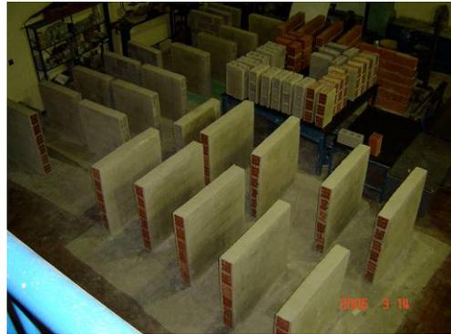
**Figura A4-2.** *Muretes y Pilas almacenados con friso*
