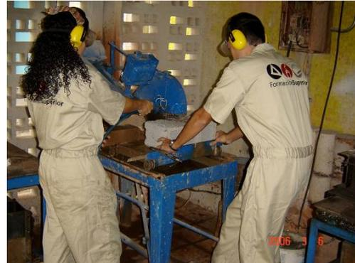
**Figura A3-2.** *Proceso de cortado, Bloques de concreto*
