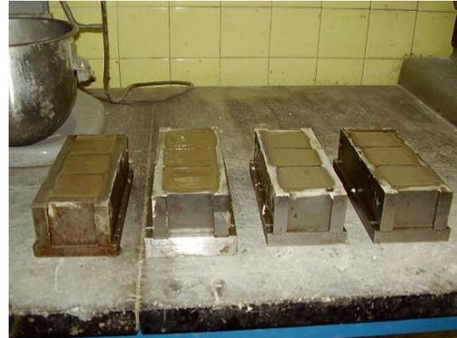
**Figura A5-2.** *Moldes para probetas*
