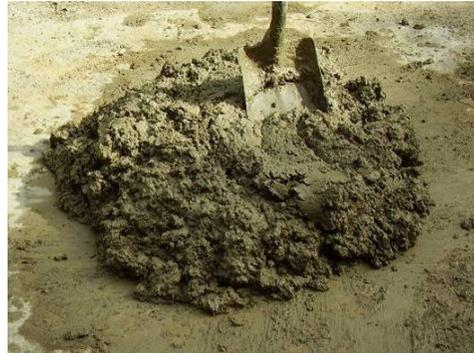
**Figura A2-12.** *Consistencia del mortero*
