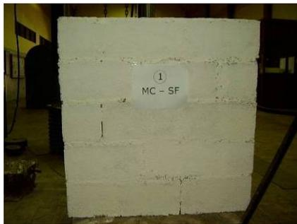
**Figura A6-6.** Nomenclatura para Muretes, construidos con bloques huecos de arcilla
