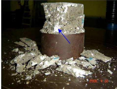
**Figura IV-31.** *Falla en Probeta 6–A*
