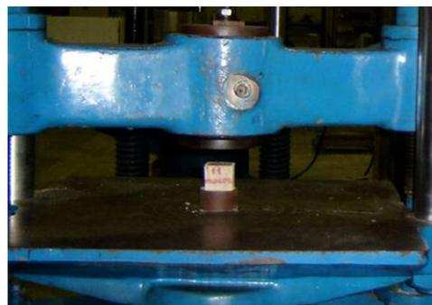
**Figura A8-8.** *Centrado de la Probeta, en la plataforma de ensayo*
