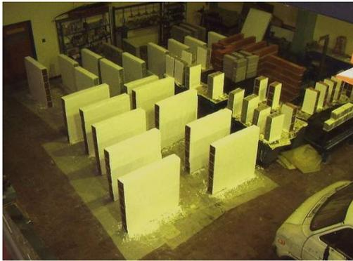
**Figura A4-3.** *Muretes y Pilas almacenados y pintados parcialmente*
