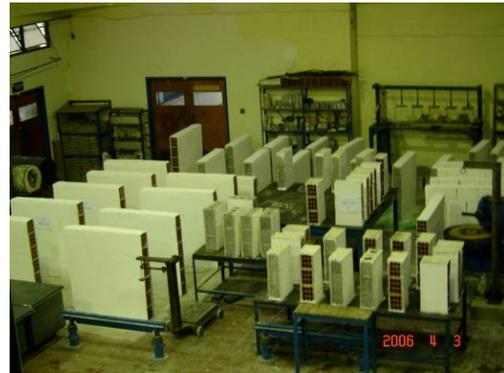
**Figura A4-4.** *Muretes y Pilas almacenados, pintados e identificados para ser ensayados*
