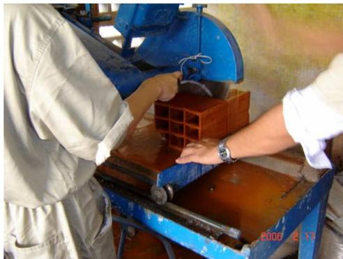
**Figura A3-3.** *Proceso de cortado, Bloques huecos de arcilla*
