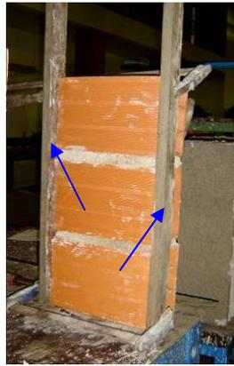
**Figura A3-13.** Listones de Madera, para fijar espesor del friso
