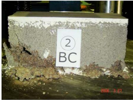
**Figura IV-12.** *Bloque de concreto luego del agotamiento*
