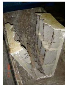
**Figura IV-28** *Fractura en PC-e2-5*
