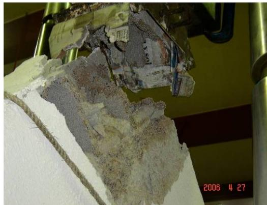
**Figura IV-68.** Falla por aplastamiento en MC-e2 - 5
