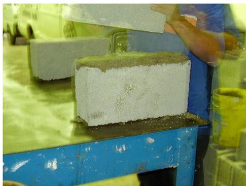
**Figura A3-9.** *Colocación primer bloque y primera capa de mortero*
