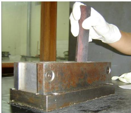
**Figura A5-3.** *Compactación del mortero*
