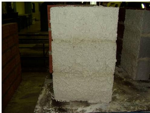
**Figura A3-15.** Friso Base, pila con bloques de concreto (salpicado)
