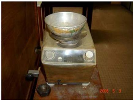
**Figura A2-6.** Balanza electrónica, Cap. 1000 gf
