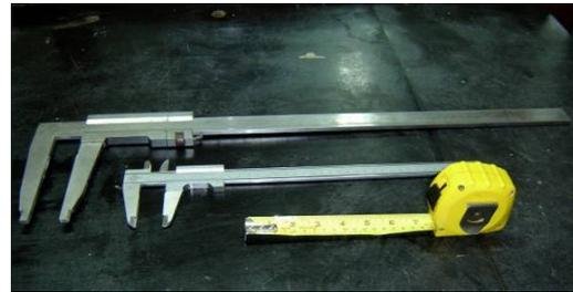
**Figura A6-2.** *Verniers de precisión y cinta métrica*
