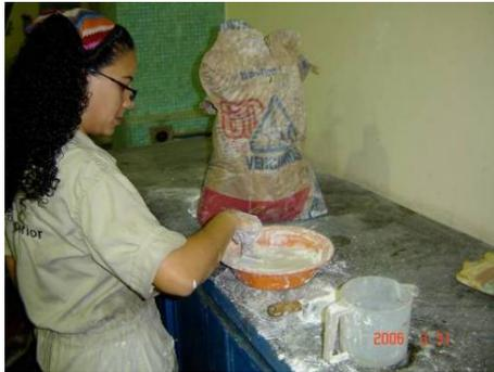
**Figura A7-1.** *Preparación de la mezcla de yeso*
