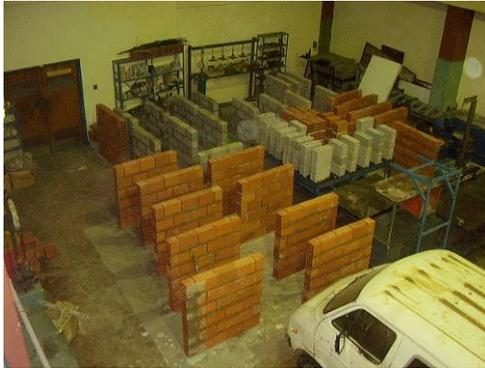
**Figura A4-1.** *Muretes y Pilas almacenados sin friso*
