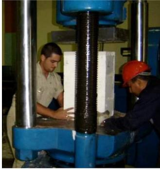
**Figura A8-4.** *Centrado de la pila con bloques de concreto en la plataforma de ensayo*
