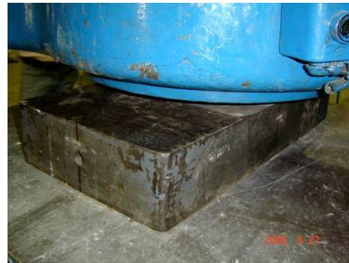
**Figura A8-3.** *Plancha rígida rectangular, rotulada*
