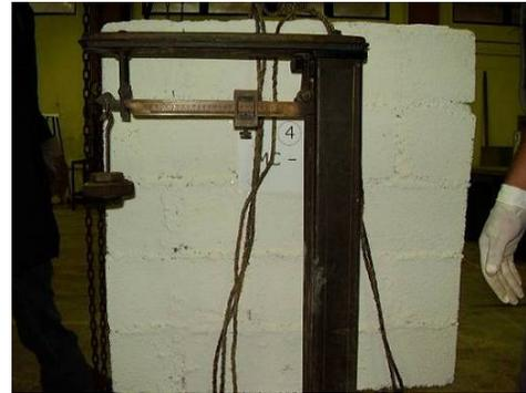
**Figura A8-10.** *Determinación del peso de los Muretes*
