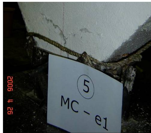
**Figura IV-67.** Falla por aplastamiento en MC-e1 - 5
