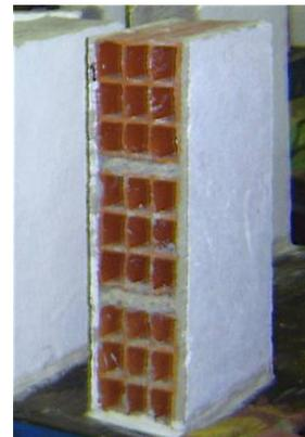
**Figura A3-16.** Pila con bloques huecos de arcilla, pintada con Cal
