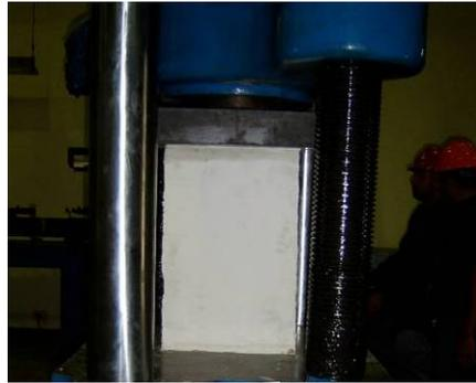
**Figura A8-6.** *Montaje de pila con bloques de concreto en la plataforma de ensayo*
