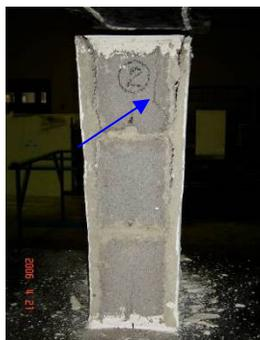
**Figura IV-27.** *Separación del friso en PC-e2-2*
