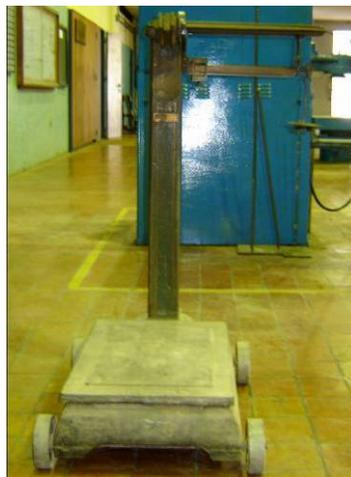
**Figura A6-3.** *Balanza mecánica Romana, Cap. 500 kgf*
