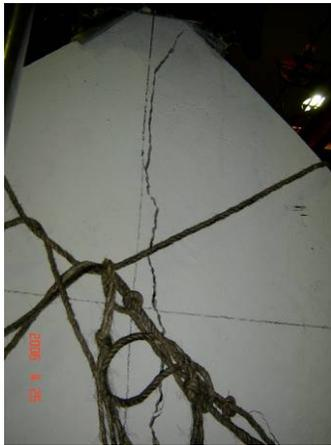
**Figura IV-66.** Falla por tracción diagonal en MC-e2 - 2
