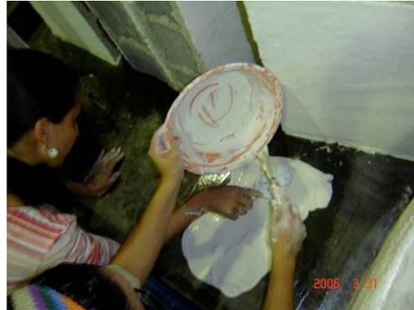
**Figura A7-2.** *Mezcla para el "capping"*
