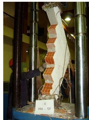
**Figura IV-37.** *Falla escalonada en MA-SF-3* **Figura IV-38.** *Falla escalonada en MA-SF-4*
