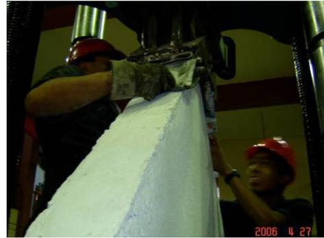
**Figura A8-16.** *Apoyo de yeso en ángulo superior*
