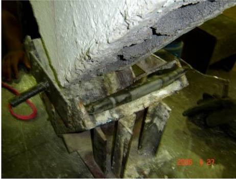
**Figura A8-15.** *Apoyo de yeso en ángulo inferior*
