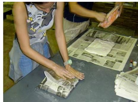
**Figura A8-14.** *Elaboración del apoyo de yeso*
