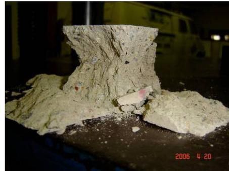
**Figura IV-30** *Detalle de falla por la interfase de la pasta y el agregado, en forma de cono*
