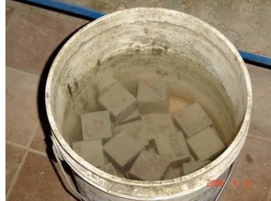
**Figura A5-4.** *Curado de las probetas*
