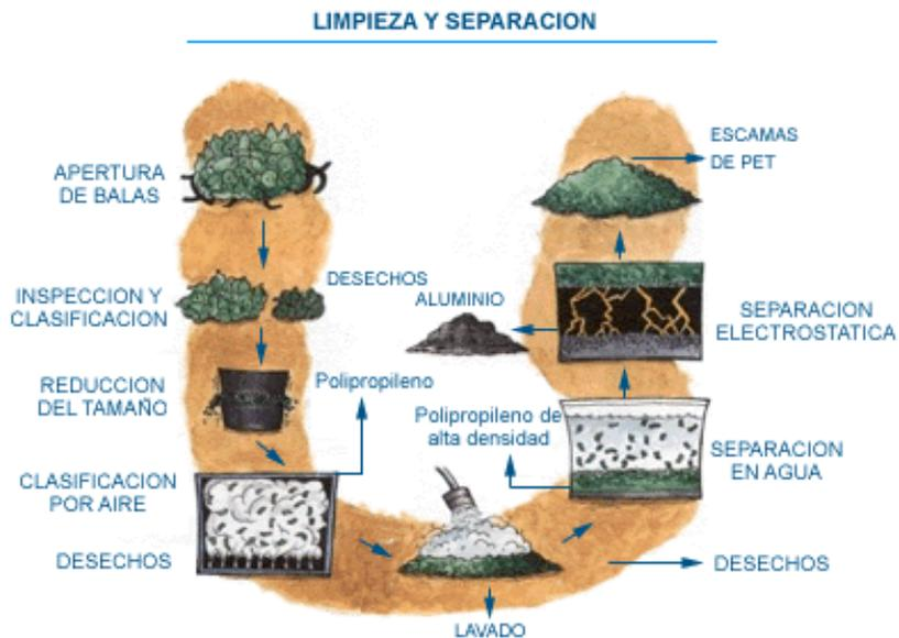
Figura 2.5. “Limpieza y Separación del PET”.<sup>19</sup>
