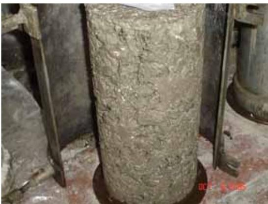
← Desencofrado de la probeta
