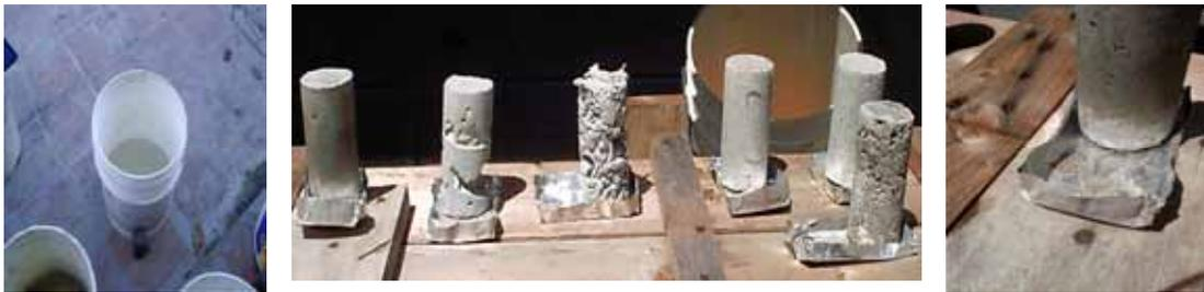
Figura 3.20.- “Erosión por Cepillado”
