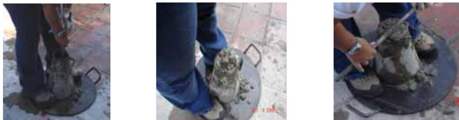
Figura 3.11. “Ejecución del Ensayo del Cono de Abrams”.
