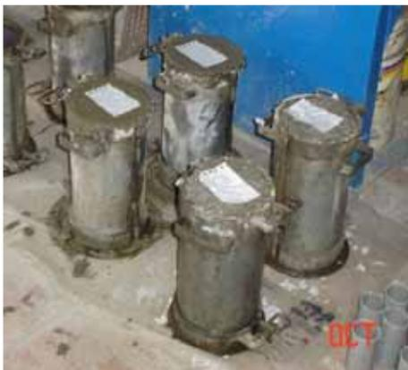
← Probetas cilíndricas normalizadas
