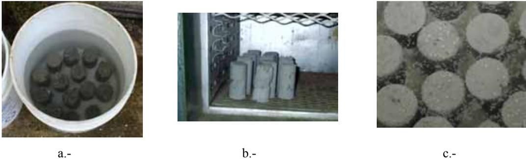
Figura 3.18.- “Ejecución del Ensayo de Absorción”.
