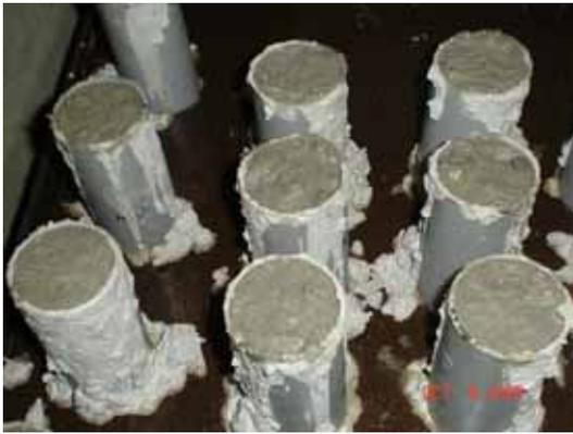
← Probetas cilíndricas pequeñas
