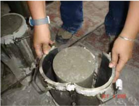
← Desencofrado de las probetas normalizadas
