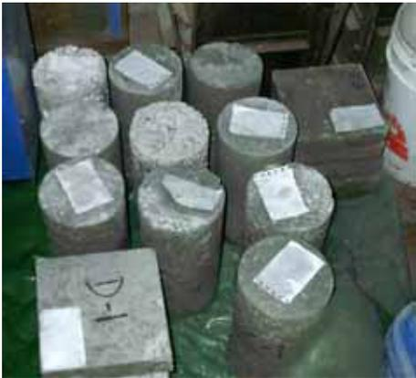
← Almacenamiento de las Probetas curadas
