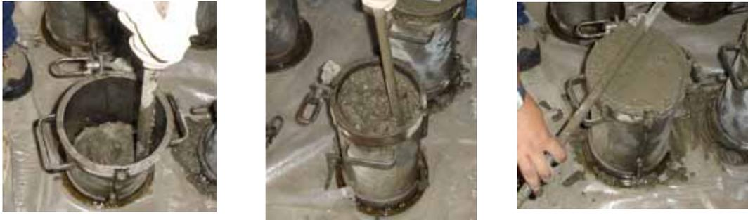
Figura 3.15. “Proceso de Elaboración de las Probetas”.
