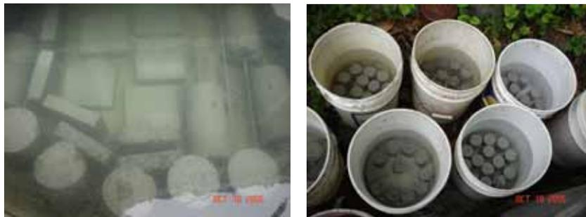
Figura 3.16.- “Curado de las Probetas”.
