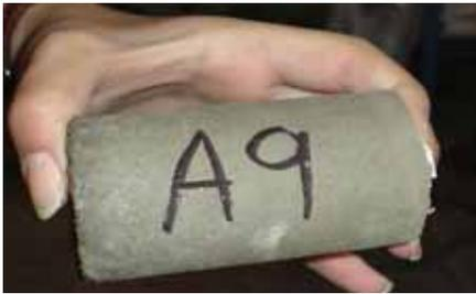
← Forma de marcar las probetas
