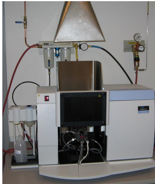
Figura 8. Absorción y Emisión Atómica (Perkin-elmer-AAAnalyst 2000)
