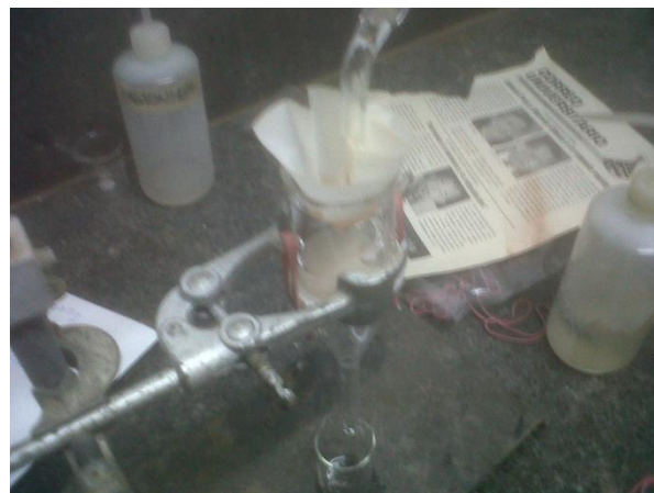
Figura 7. Montaje de filtro de pliegue con placa de micropore y papel de filtro de milipore.
