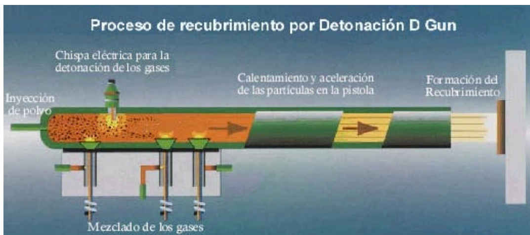
Figura 1.8.- Esquema de la pistola de rociado térmico modelo D-GUN.
