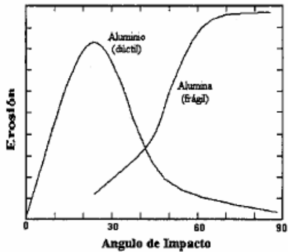
Figura 1.14.- Variación de la erosión con el ángulo de impacto característico de materiales dúctiles y frágiles.
