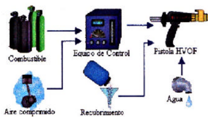
Figura 1.10.- Esquema de un sistema de rociado térmico HVOF
