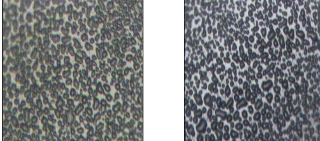
Figura 50. Micrografías de núcleos de Cu-CuO a -0,074 V durante 120s.
