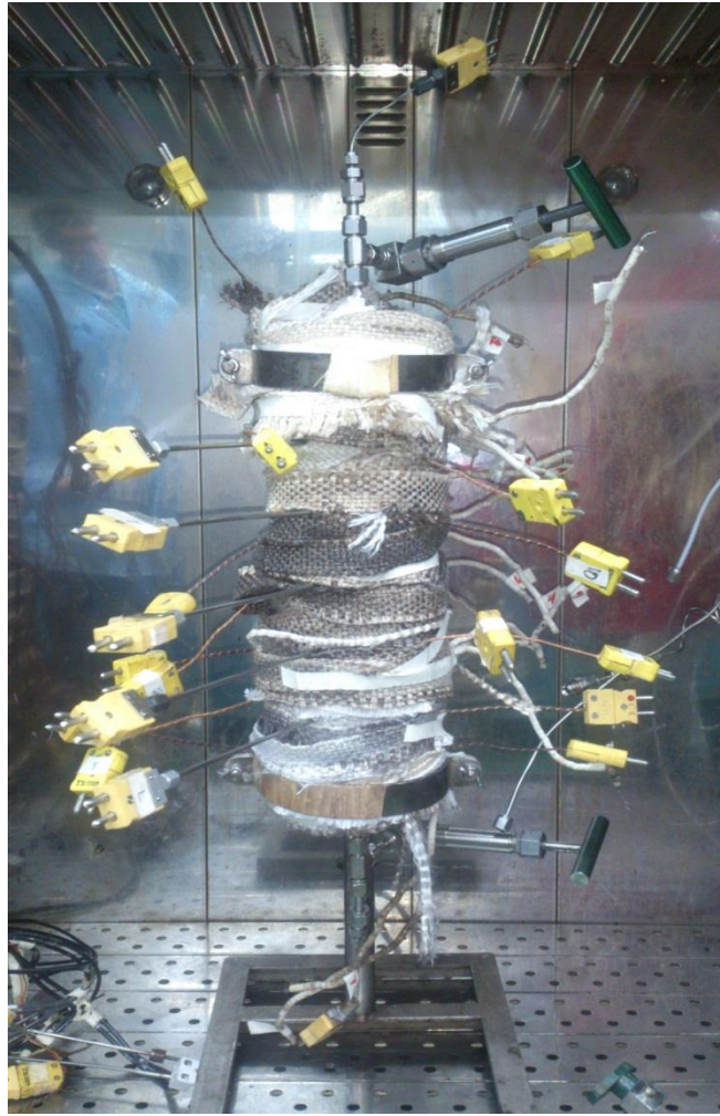
Figura 30: Celda de combustión con aislamiento
