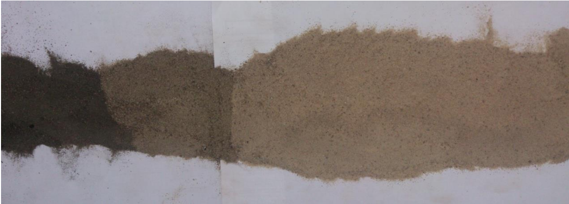
Figura 23: Apariencia de la arena luego de finalizar la prueba con calentamiento eléctrico
