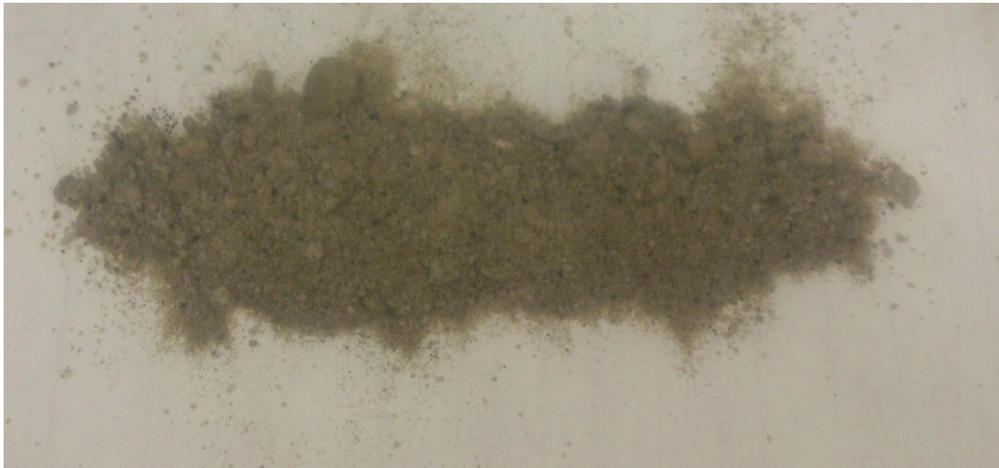
Figura 25: Apariencia de la arena luego de finalizar la prueba de precalentamiento con vapor
