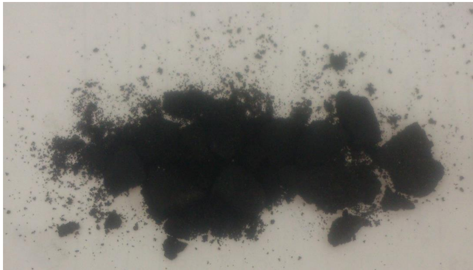
Figura 24: Cantidad de coque producido por prueba de ignición de precalentamiento con vapor
