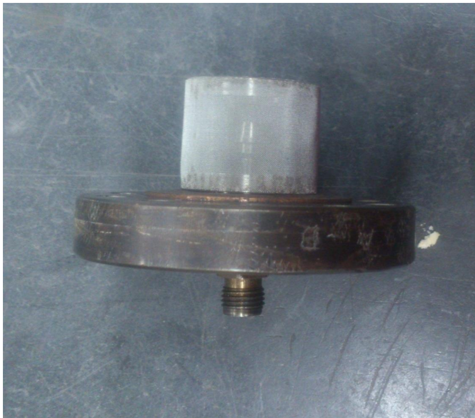
Figura 27: Diseño de las tapas acoplada a la celda para la introducción de agentes químicos
